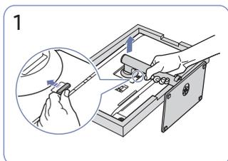
Coloque el producto en un piso limpio y plano como se muestra en la figura. Mantenga presionada la tecla hacia arriba. Gire el cuello del soporte de la pantalla 10° en sentido contrario a las agujas del reloj.
