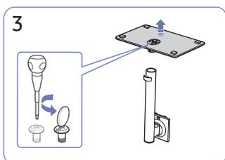
Desajuste el tornillo de conexión en la parte inferior de la base del soporte y, luego, retire el cuello del soporte de la base. Para ello, hale el cuello del soporte en la dirección de la flecha como se muestra en la figura.
