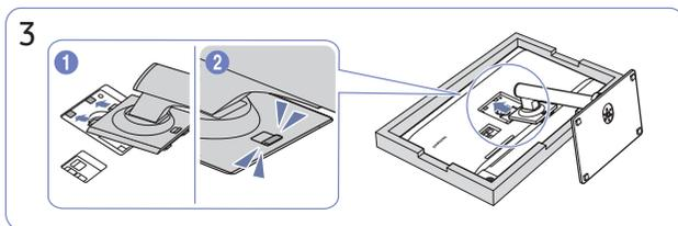
Coloque el cuello del soporte en la pantalla como se muestra en la figura.
