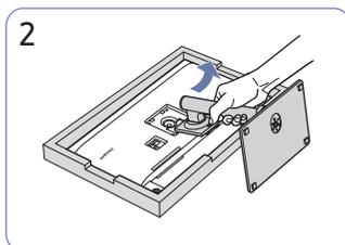
Levante el cuello del soporte en la dirección de la flecha para retirarlo de la pantalla.
