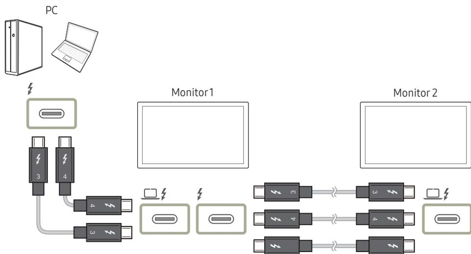
La compatibilidad con la pantalla doble (conexión en serie) depende de su computadora y del cable Thunderbolt™ 3 / 4 conectado. El puerto Thunderbolt™ 3 de su computadora debe admitir una salida doble de 4 K a 60 Hz, y el cable Thunderbolt™ 3 / 4 de 40Gbps en particular (🔌🔌) deben comprarse por separado. Para obtener especificaciones detalladas del cable Thunderbolt™ 3 / 4, visite el sitio web oficial de Thunderbolt.
