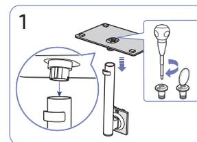
Coloque la base del soporte sobre el cuello del soporte, de acuerdo con la dirección que se muestra en la figura. Gire completamente el tornillo de conexión en la parte inferior del soporte para que quede firmemente sujeto.
