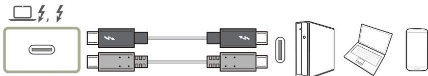
De acuerdo con la especificación de USB Power Delivery 3.0, nuestro producto puede cargar su computadora cuando ambos se conectan mediante un cable Thunderbolt™ 3 / 4.
