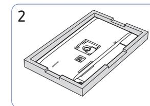
Ubique sobre el piso el acolchado protector de poliestireno extrusionado (Styrofoam) incluido en el paquete y, a continuación, ubique el producto boca abajo sobre el protector, como se muestra en la imagen. Si no dispone del protector de Styrofoam, use una esterilla gruesa.
