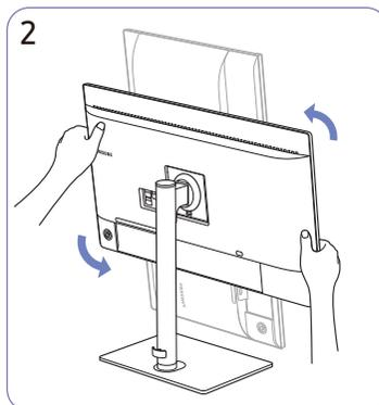
2 Faites pivoter le produit dans la position verticale la plus haute.
