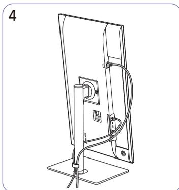
4 Placez les deux câbles dans le dispositif de maintien de câbles sur le support (CÂBLE DU SUPPORT DU GUIDE) pour organiser les câbles, comme indiqué sur la figure.
