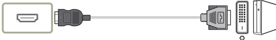
— La fonction audio n'est pas prise en charge si le périphérique source est connecté à l'aide du câble HDMI-DVI.
