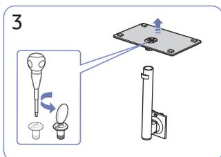
Dévissez la vis en bas de la base du support, puis retirez le tube du support de la base du support en le tirant dans le sens de la flèche, comme indiqué sur la figure.
