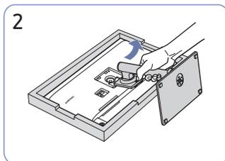
Soulevez le tube du support dans le sens de la flèche pour le détacher de l'écran.
