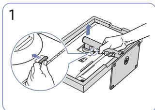
Placez l'appareil sur une surface propre et plane comme indiqué sur la figure. Appuyez vers le haut sur la touche et maintenez-la enfoncée. Faites tourner le support de l'écran de 10 degrés dans le sens inverse des aiguilles d'une montre.
