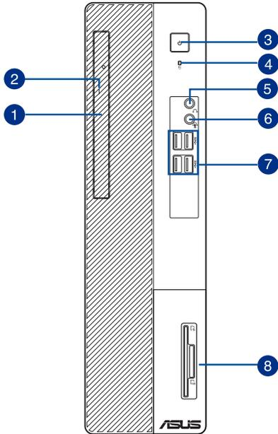
1. **5,25-Zoll-Laufwerkschacht für optisches Laufwerk (optional).** In diesem Laufwerksfach befindet sich ein optisches Laufwerk.
