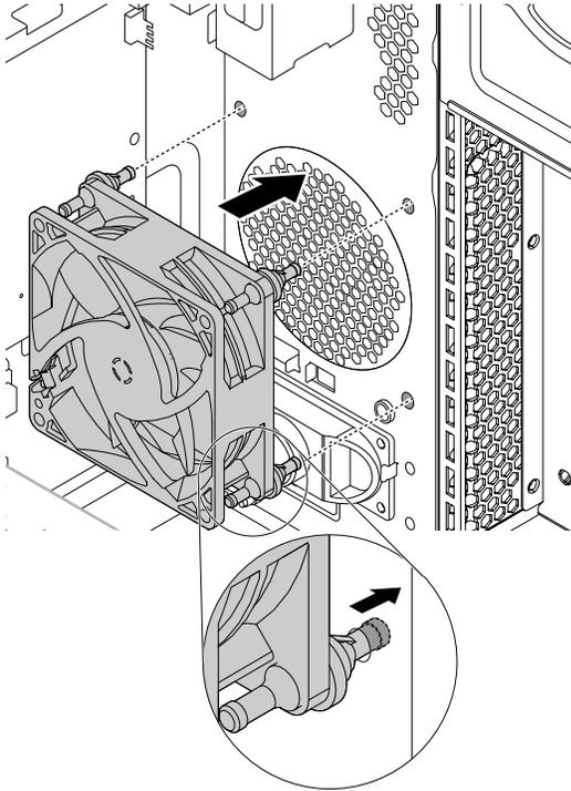
Figure 123. Installing the front fan
