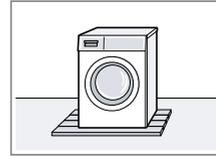
Das Gerät auf einer wasserbeständigen Holzplatte aufstellen, die fest mit dem Fußboden verschraubt ist. Die Stärke der Holzplatte sollte mindestens 30 mm betragen.
