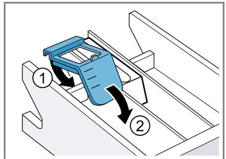
3. Die Waschmittelschublade einsetzen.
