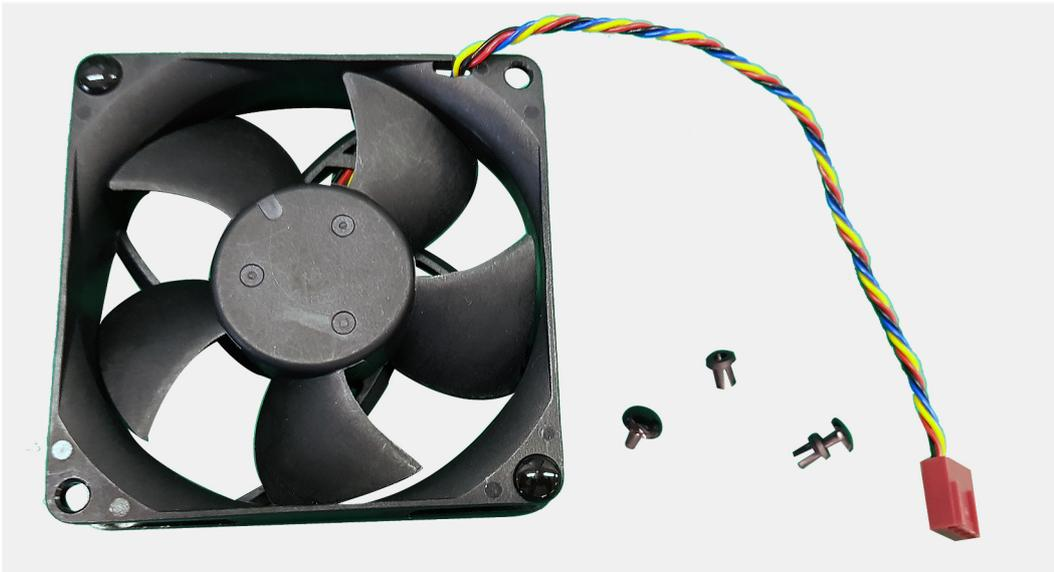
2. Führen Sie die Gummidichtungen durch die Aussparungen am Lüfter und drücken Sie die Gummidichtungen, bis der Lüfter einrastet.
