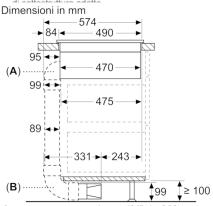
A: con connettore ad arco "M" da 90' B: con connettore ad arco "L" da 90°
