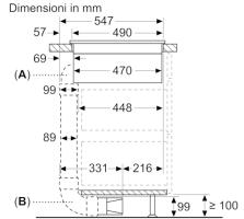
A: con connettore ad arco "S" da 90' B: con connettore ad arco "L" da 90°
