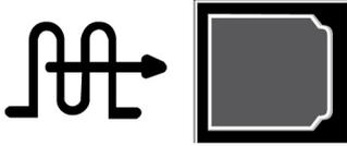
**Optical S/PDIF port** (Optischer S/PDIF-Anschluss) – Überträgt digitale Audiosignale mithilfe optischer Signale, ohne dass hierfür eine Analog-Audio-Konvertierung erforderlich ist.
