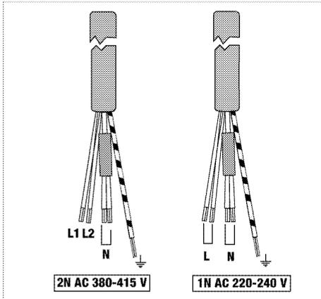
2. Bei Einphasenanschluss erfolgt der Anschluss der Kabel wie folgt:
