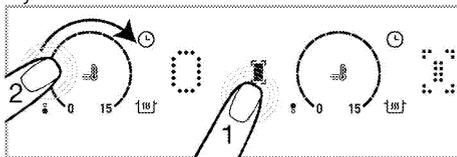
3. Durch Berühren des Einstellbereiches und indem Sie mit dem Finger darüber streichen, wählen Sie eine Temperaturstufe zwischen 0 und 15.
