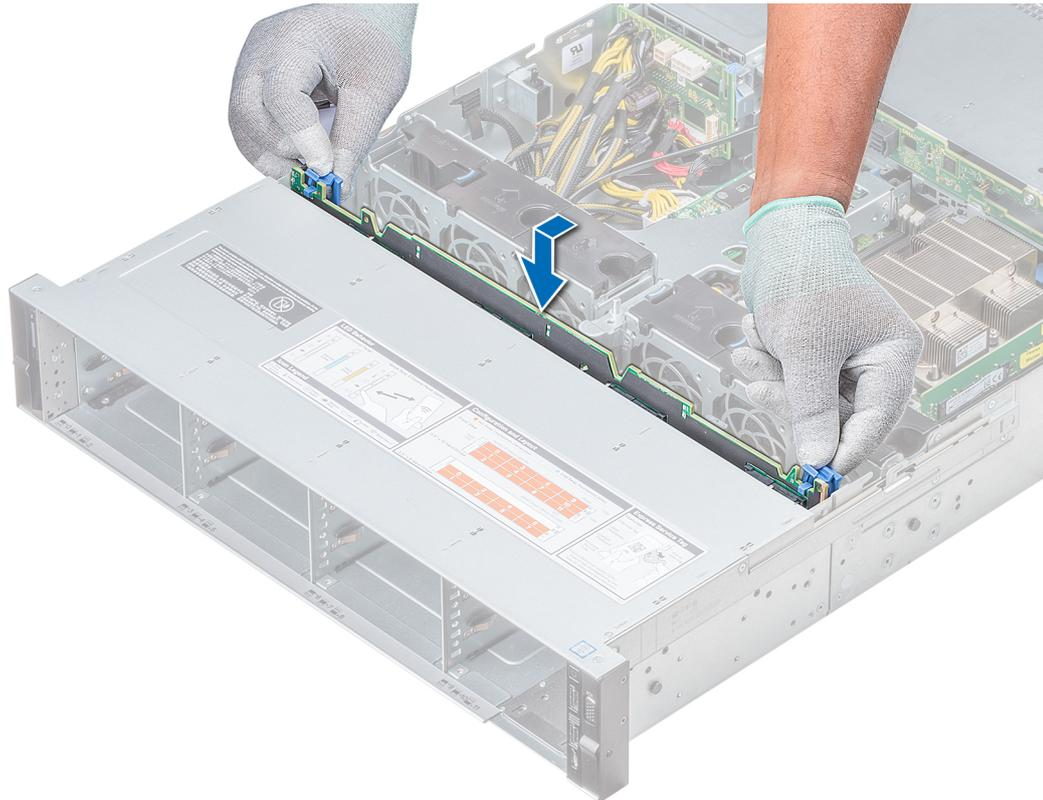
Abbildung 102. Installieren der Rückwandplatine
