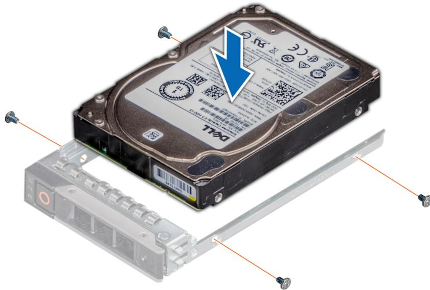
Abbildung 54. Einsetzen eines Laufwerks in den Laufwerksträger
