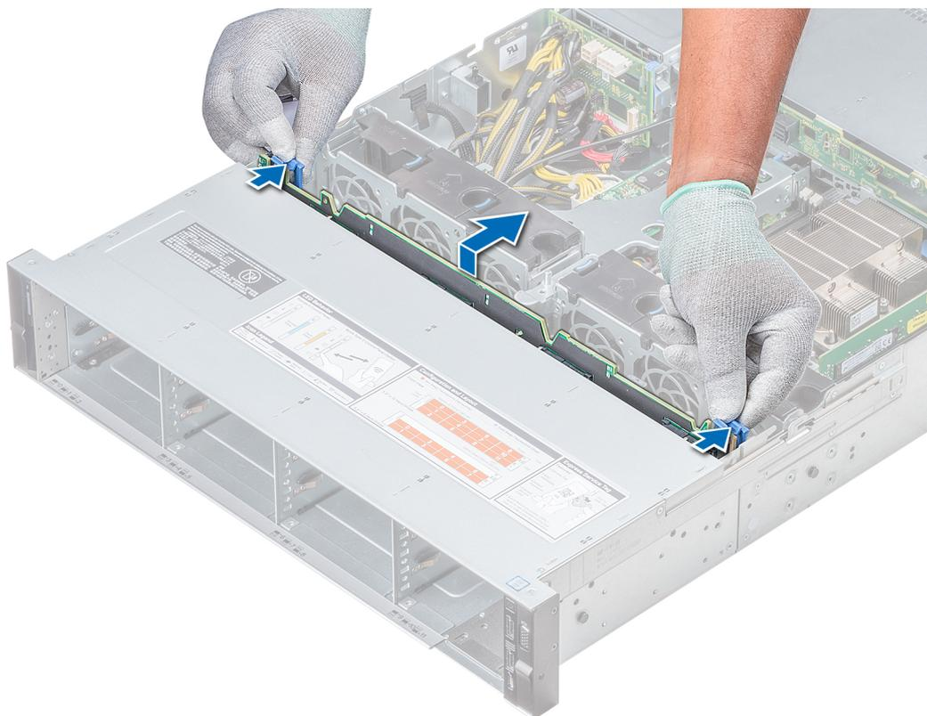
**Abbildung 101. Entfernen der Rückwandplatine**
