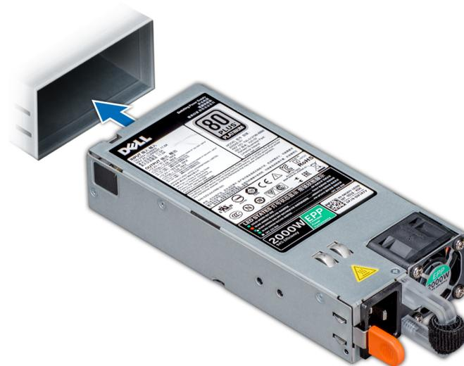
Abbildung 117. Netzteil installieren
