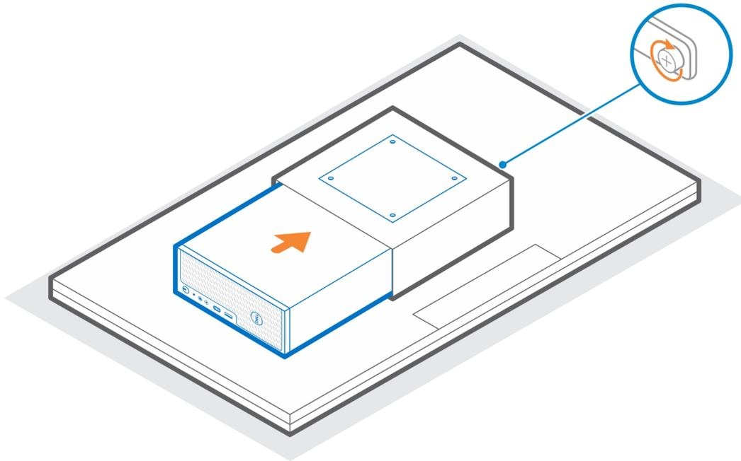
7. Alignez les trous de vis de la plaque d'adaptateur VESA avec ceux du support du manchon VESA.
