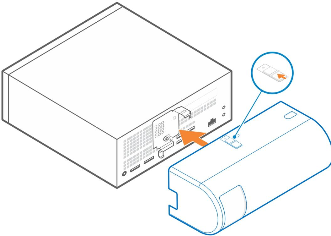
**REMARQUE :** Pour renforcer la sécurité, utilisez le verrouillage de câble Kensington pour fixer l'unité système.
