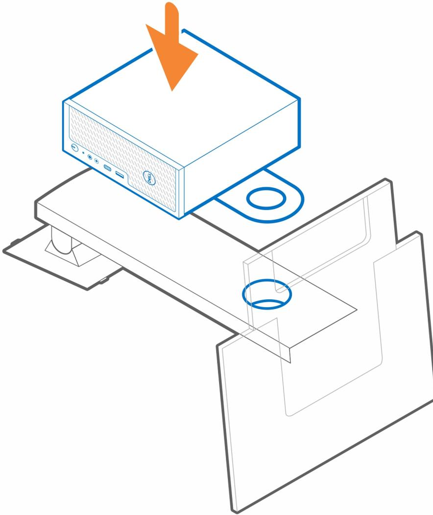
7. Installez le socket [1] du côté de l'écran dans le logement de gestion des câbles.
