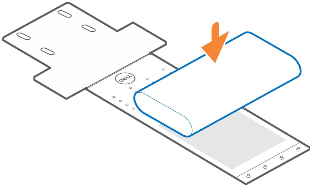
5. Entourez l'adaptateur CA avec le manchon et insérez les languettes de fixation dans les trous à un niveau approprié.
