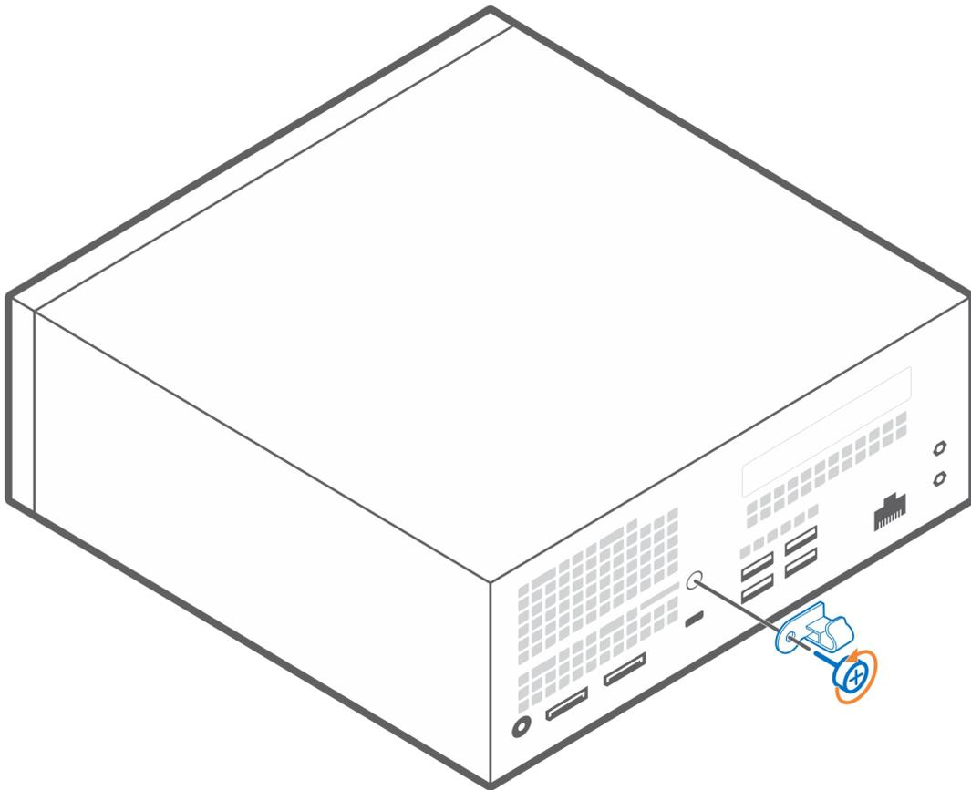
3. Alignez le support arrière avec le serre-câble à l'arrière du système.
