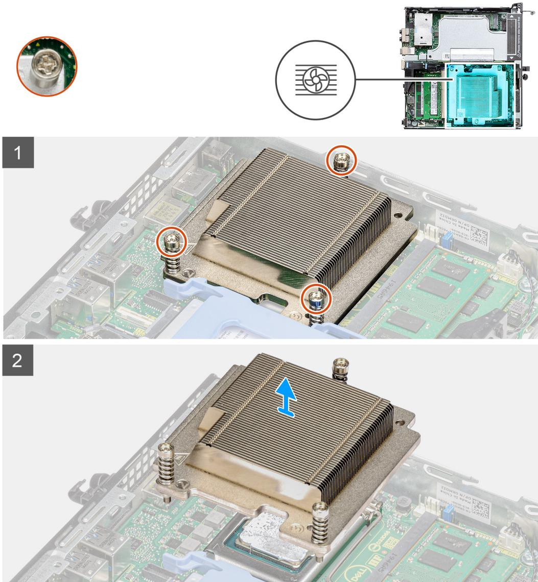
Abbildung 4. Kühlkörper im Lieferumfang der Systemkonfiguration mit 65-W-CPU
