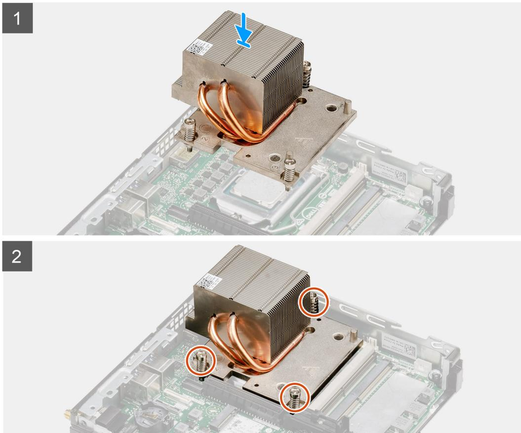
Abbildung 7. Kühlkörper im Lieferumfang der Systemkonfiguration mit 80-W-CPU
