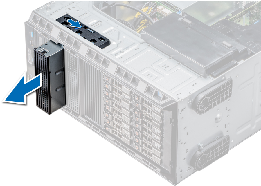
Ilustración 37. Extracción de la unidad óptica o unidad de cinta de relleno
