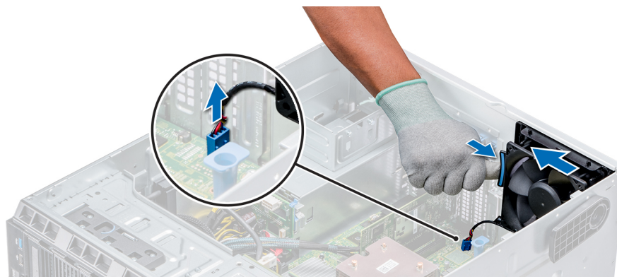
Ilustración 55. Extracción del ventilador de refrigeración interno
