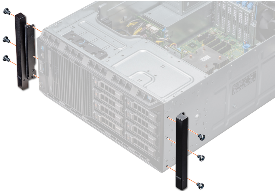
Ilustración 95. Instalación de las orejas del sistema
