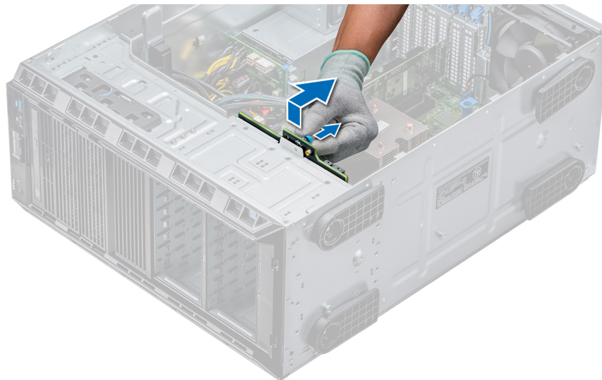
Ilustración 50. Extracción del backplane
