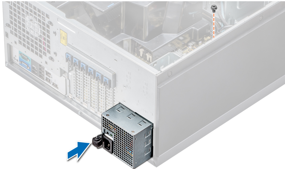
Ilustración 83. Instalación de una PSU cableada
