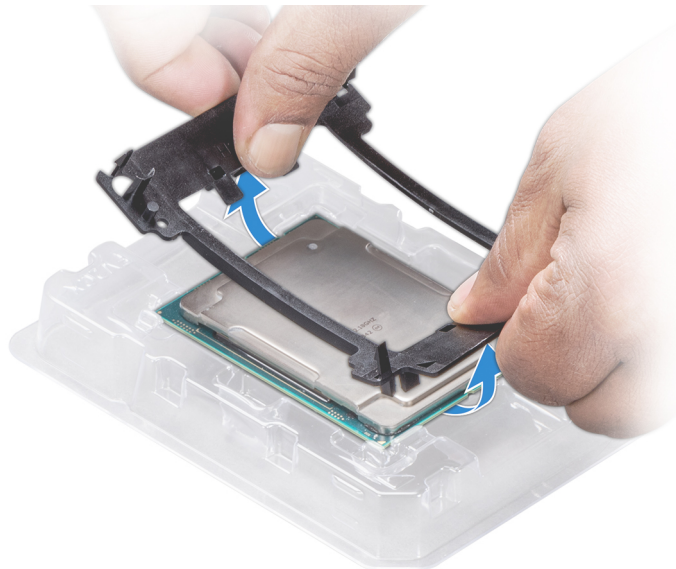
Ilustración 73. Extracción del soporte del procesador
