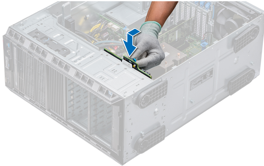
Ilustración 51. Instalación de un backplane de la unidad de disco duro
