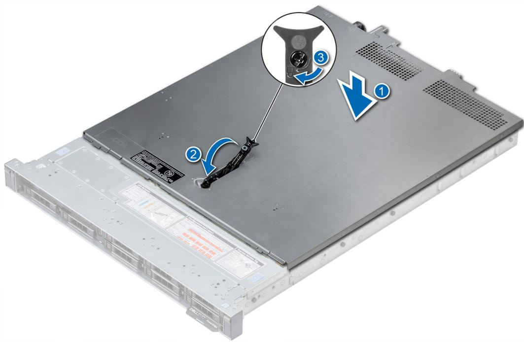
Figure 19. Installation du capot du système
