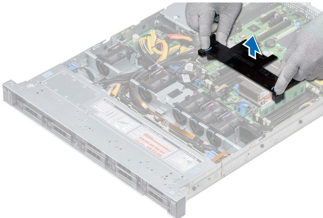
Figure 23. Retrait du carénage d'aération
