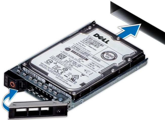
Figure 36. Installation d'un disque dur
