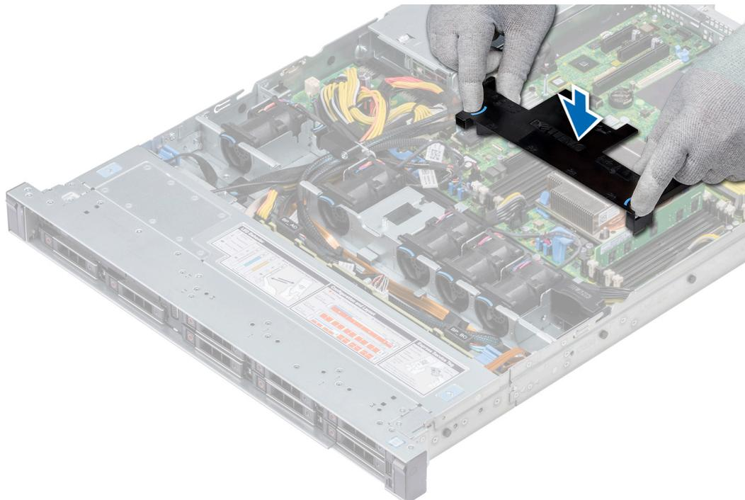
Figure 24. Installation du carénage d'aération
