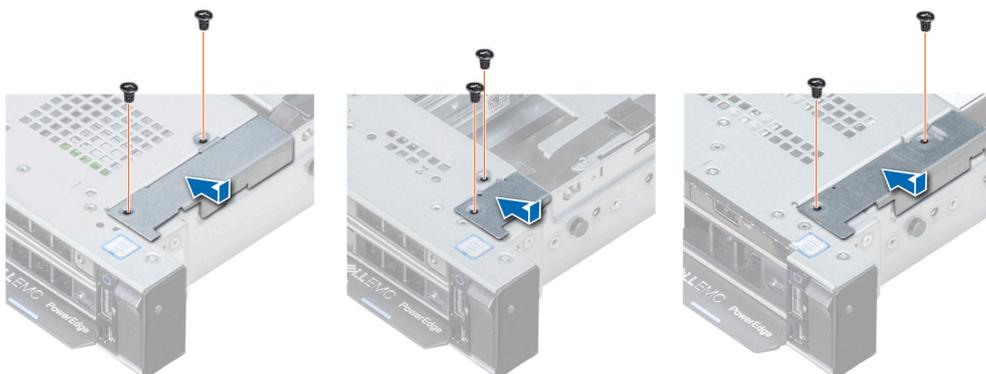
Figure 111. Installation du cache-câbles
