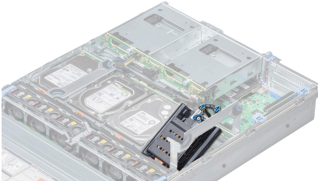
Abbildung 42. Entfernen des NVDIMM-N-Akkus aus dem mittleren Laufwerksfach
