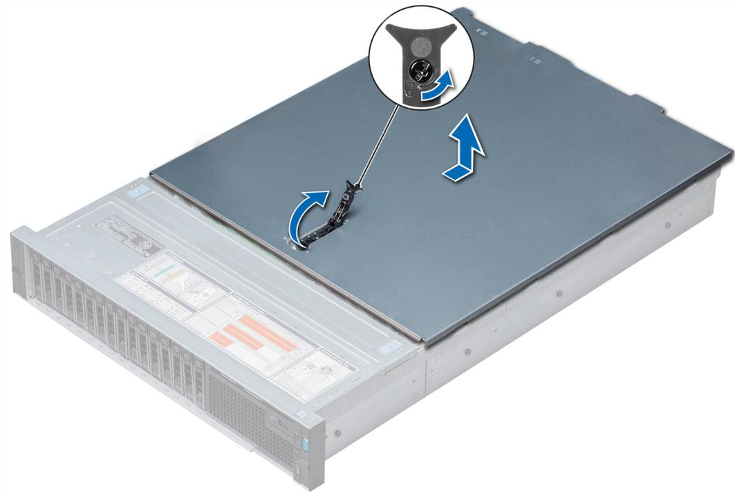
Abbildung 26. Entfernen der Systemabdeckung
