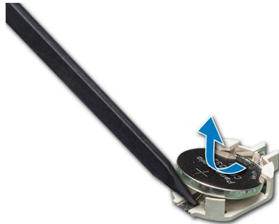
Abbildung 123. Entfernen der Systembatterie
