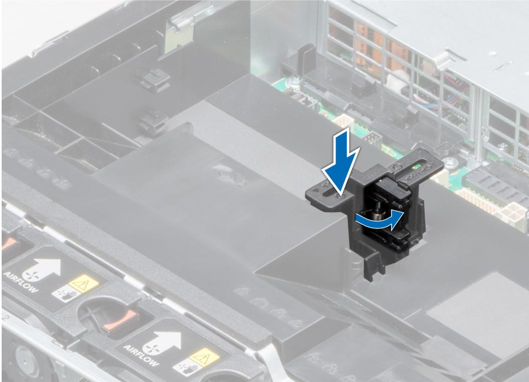
**Abbildung 67. Öffnen des PCIe-Kartenhalterverriegelung**
