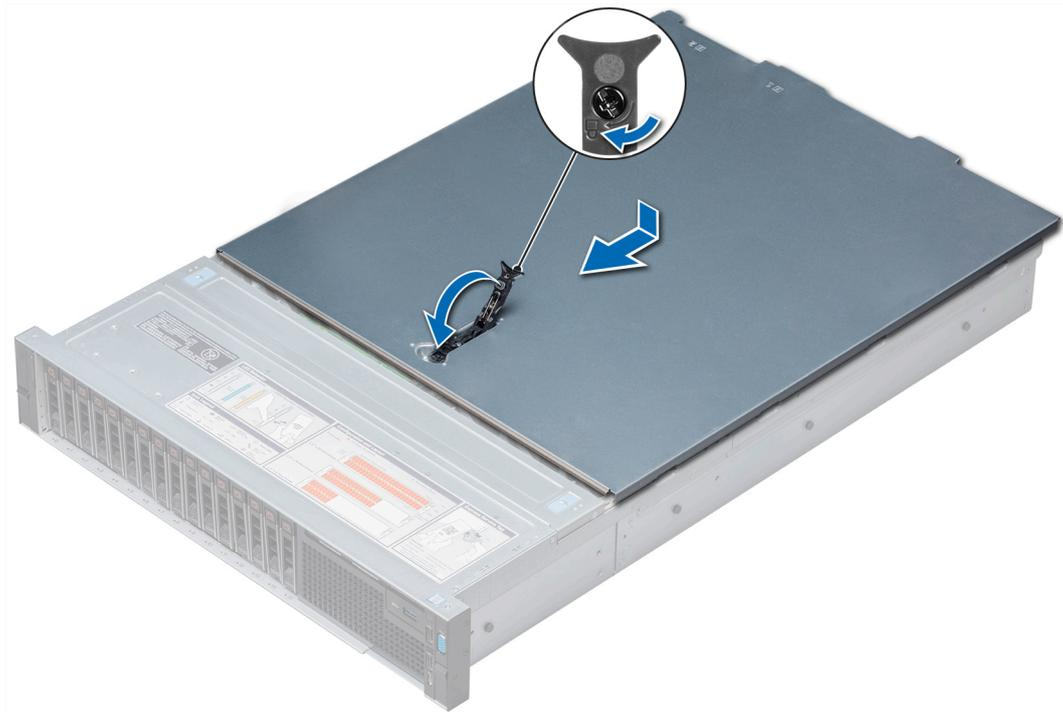
Abbildung 27. Installieren der Systemabdeckung
