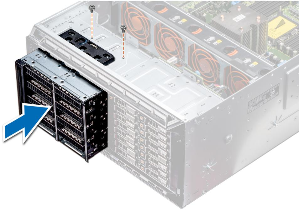
**Ilustración 58. Instalación de un compartimento para unidades NVMe o Flexbay**
