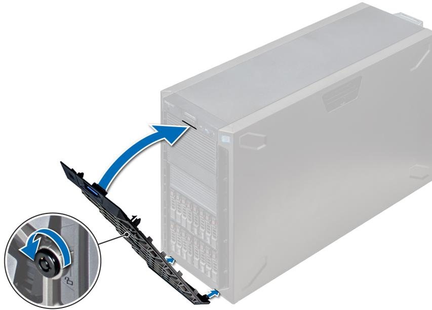
Ilustración 26. Instalación del bisel frontal
