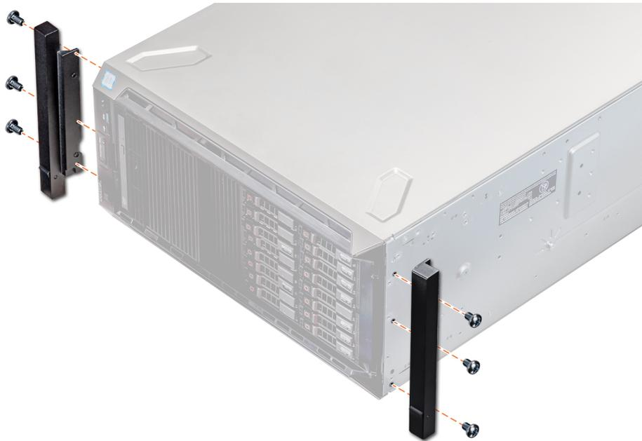
**Ilustración 122. Instalación de las orejas del sistema**
