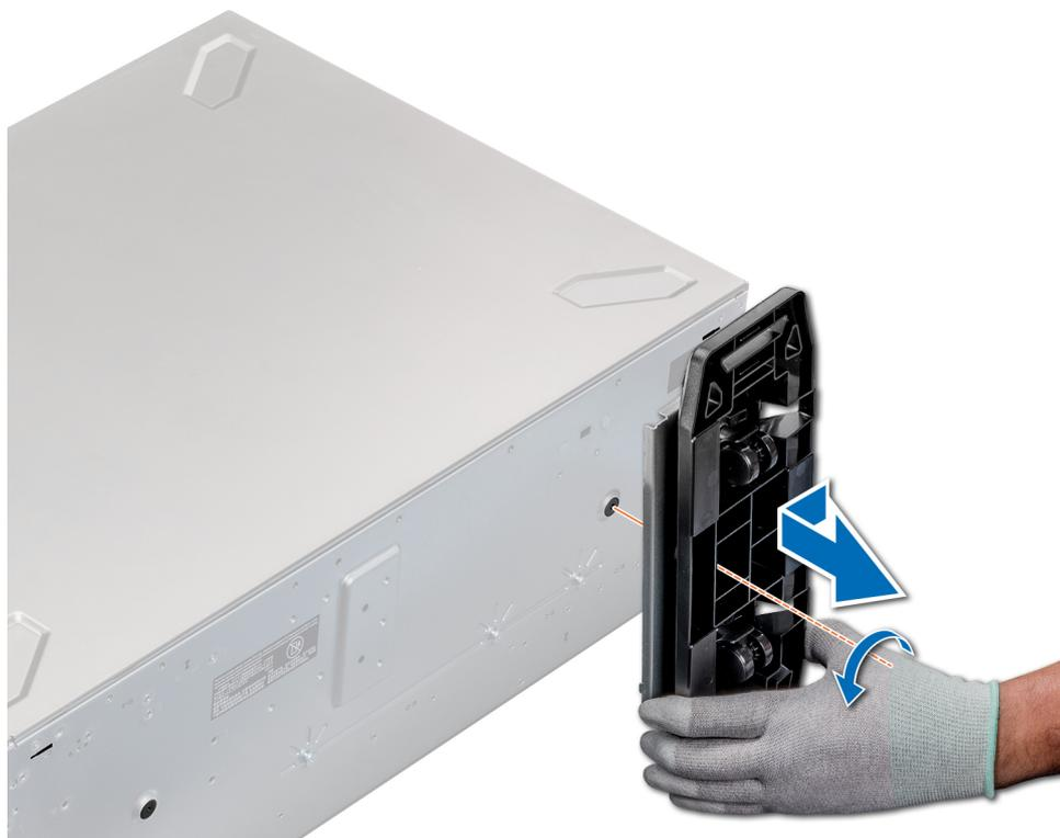
**Ilustración 29. Extracción de las ruedas giratorias**
