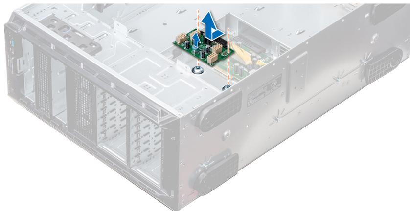
**Ilustración 116. Extracción de la placa mediadora de alimentación GPU**
