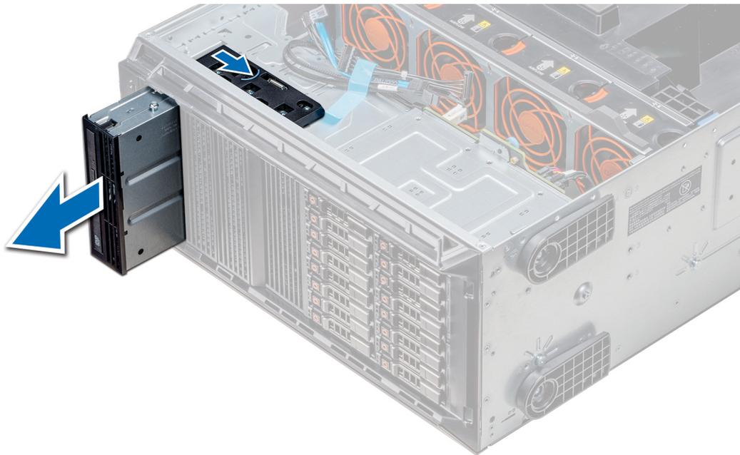
**Ilustración 61. Extracción de la caja de la unidad óptica o la unidad de cinta**
