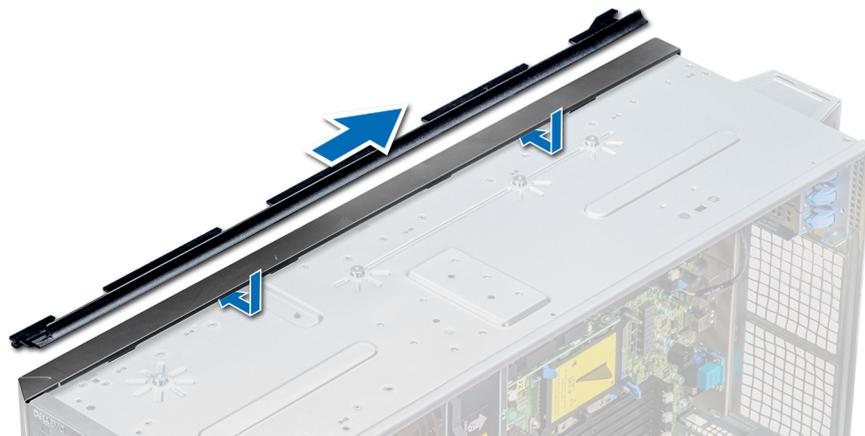
**Ilustración 120. Instalación de la cubierta de deslizamiento del bastidor**
