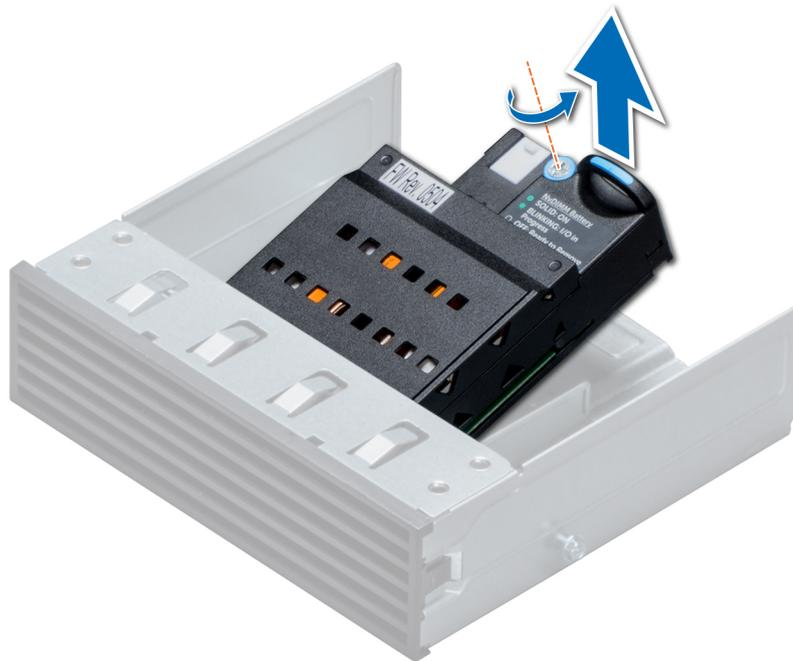
Ilustración 65. Extracción de la batería NVDIMM-N
