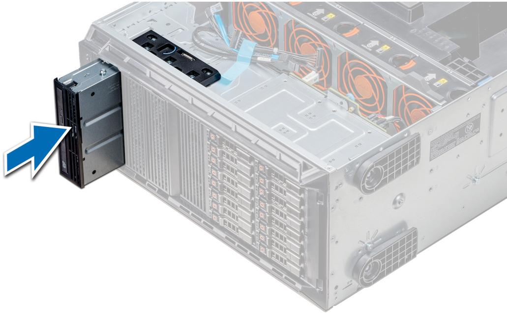
**Ilustración 62. Instalación de la caja para unidad óptica o unidad de cinta**
