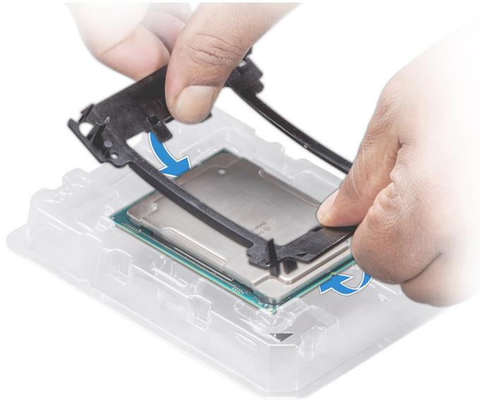
**Ilustración 73. Instalación del soporte del procesador**
