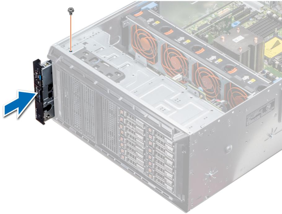
Ilustración 109. Instalación del ensamblaje del panel de control
