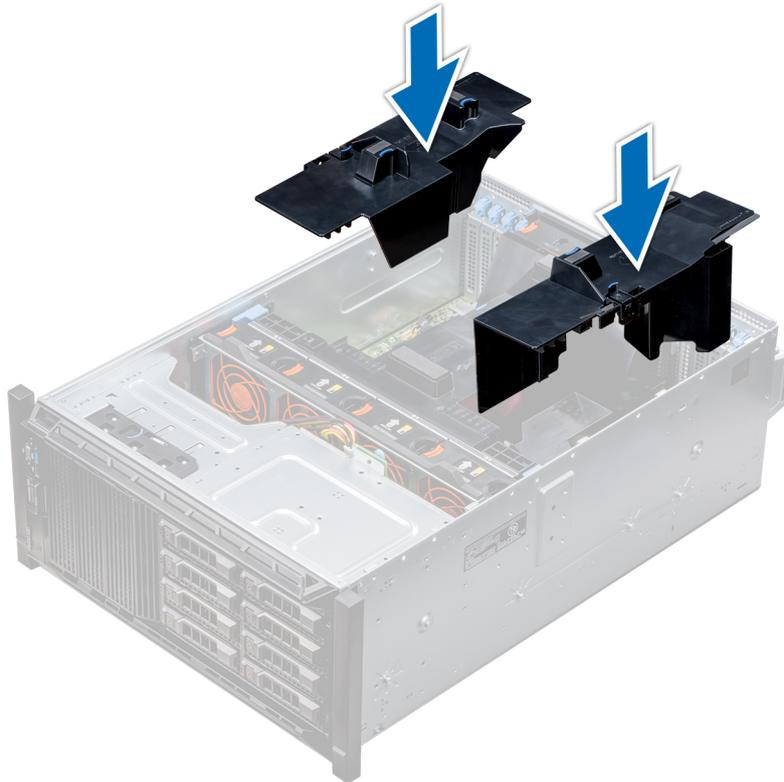
**Ilustración 48. Instalación de las cubiertas para flujo de aire de GPU opcionales**
