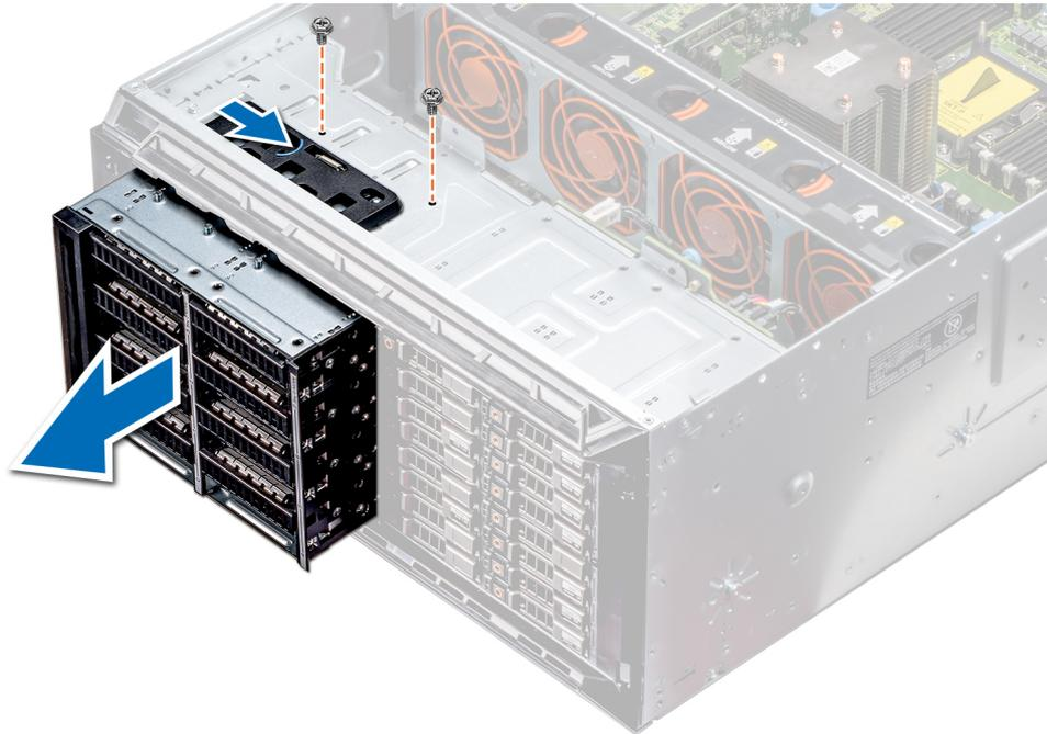
**Ilustración 57. Extracción de un compartimento para unidades NVMe o un compartimento flexible**
