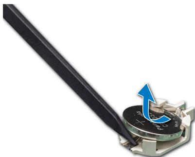
**Ilustración 104. Extracción de la batería del sistema**
