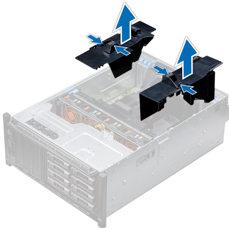
Ilustración 47. Extracción de las cubiertas para flujo de aire de GPU opcionales
