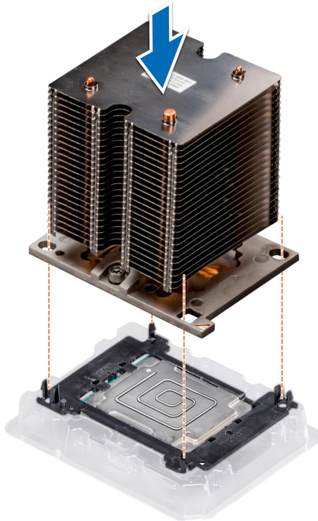
**Ilustración 75. Instalación del dissipador de calor en el procesador.**
