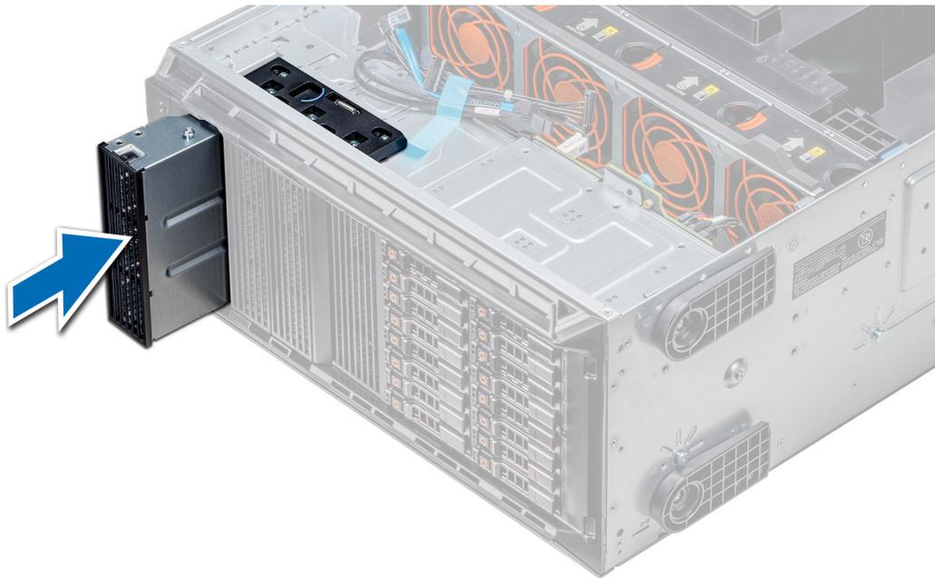
**Ilustración 60. Instalación de la unidad óptica o de cinta de relleno**
