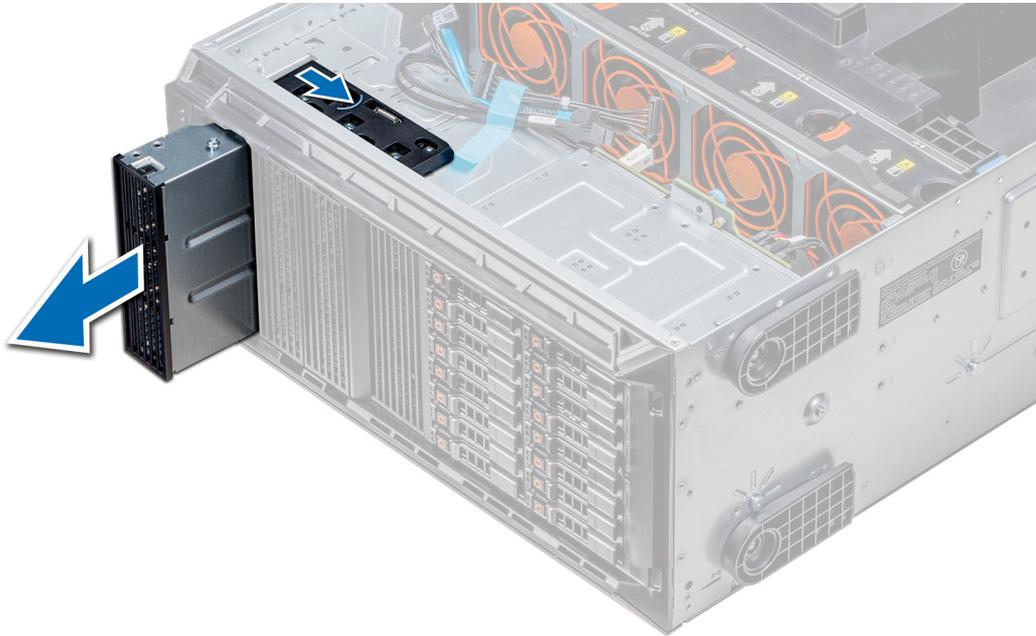
**Ilustración 59. Extracción de la unidad óptica o de cinta**
