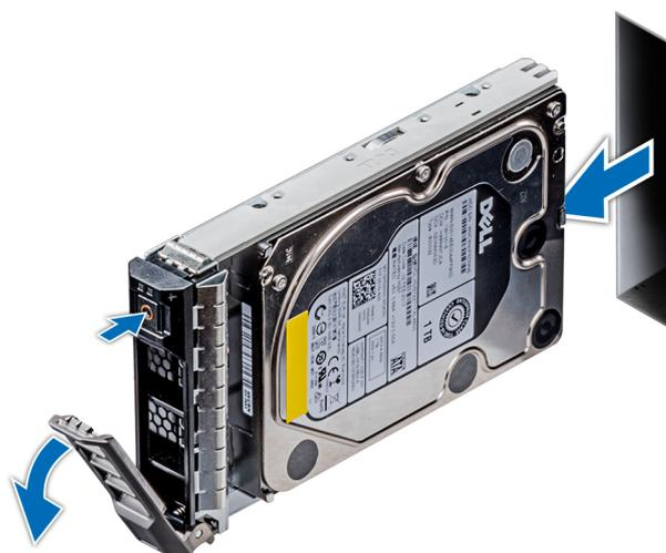
Ilustración 33. Extracción de un portaunidades
