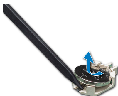
Ilustración 106. Extracción de la batería del sistema
