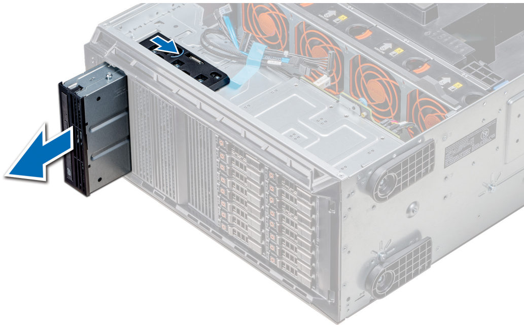
Ilustración 56. Extracción de la caja de la unidad óptica o la unidad de cinta
