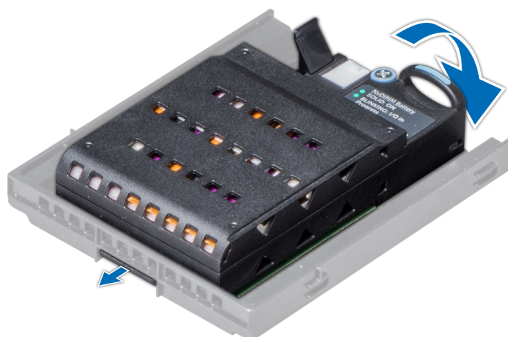
Ilustración 45. Instalación de la batería NVDIMM-N en el soporte
