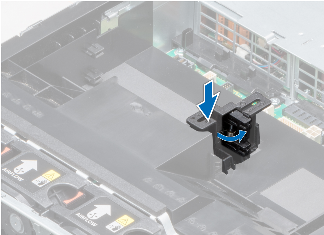
Ilustración 67. Cómo abrir el pestillo del soporte de tarjeta PCIe
