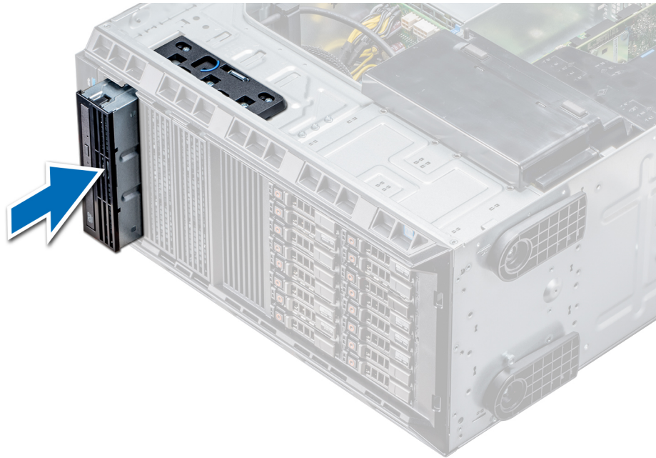
Ilustración 40. Instalación de la caja de la unidad óptica o la unidad de cinta
