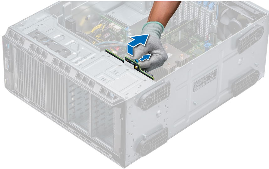
Ilustración 50. Extracción del backplane
