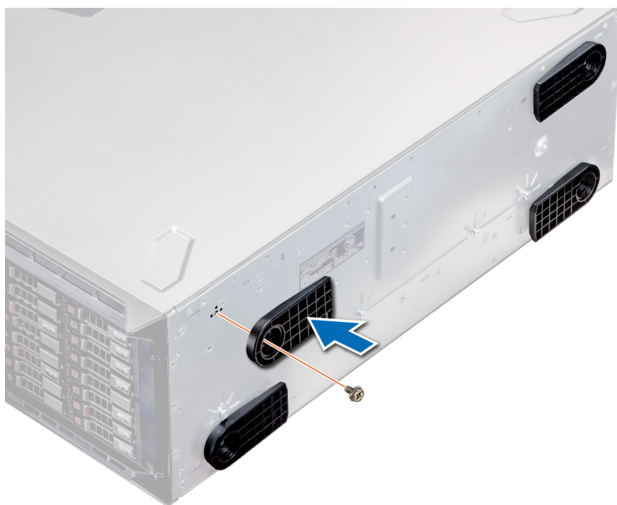
Ilustración 18. Instalación de los pies del sistema
