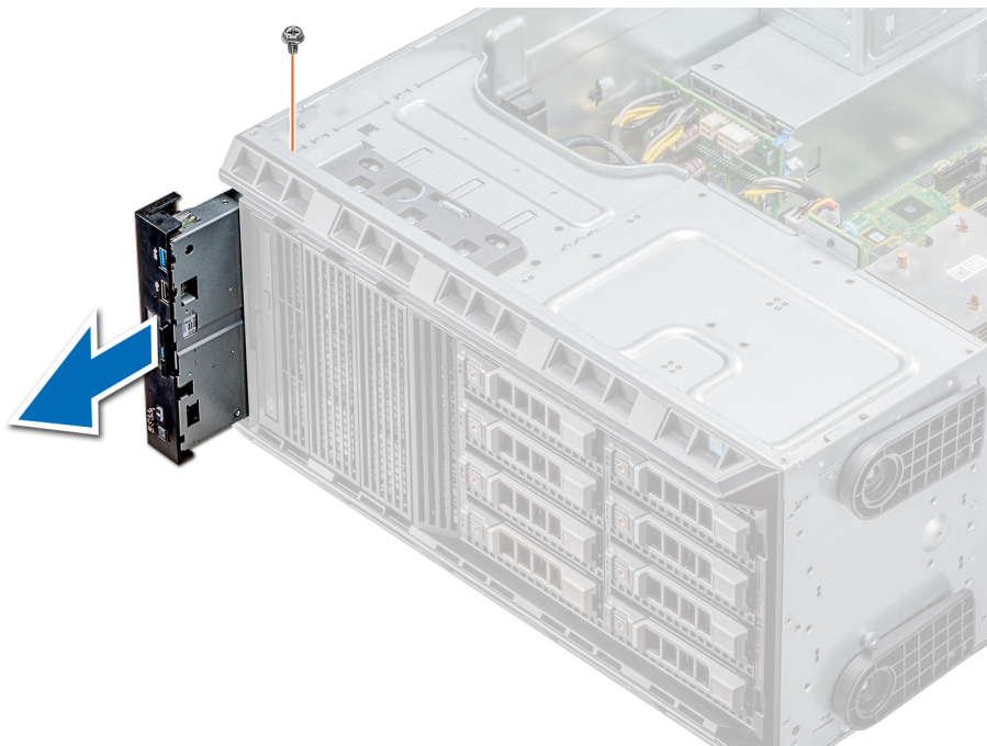
Ilustración 88. Extracción del ensamblaje del panel de control
