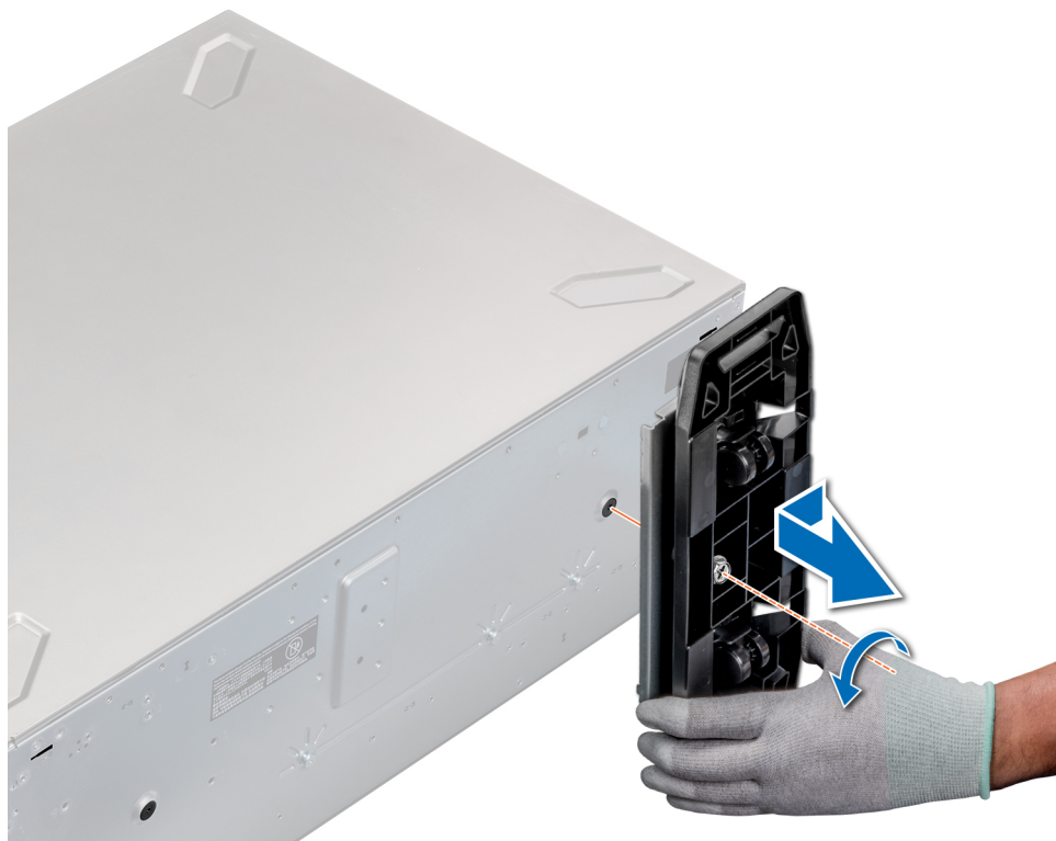
Ilustración 21. Extracción de las ruedas giratorias
