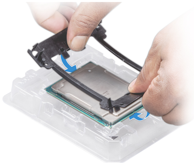
Ilustración 74. Instalación del soporte del procesador
