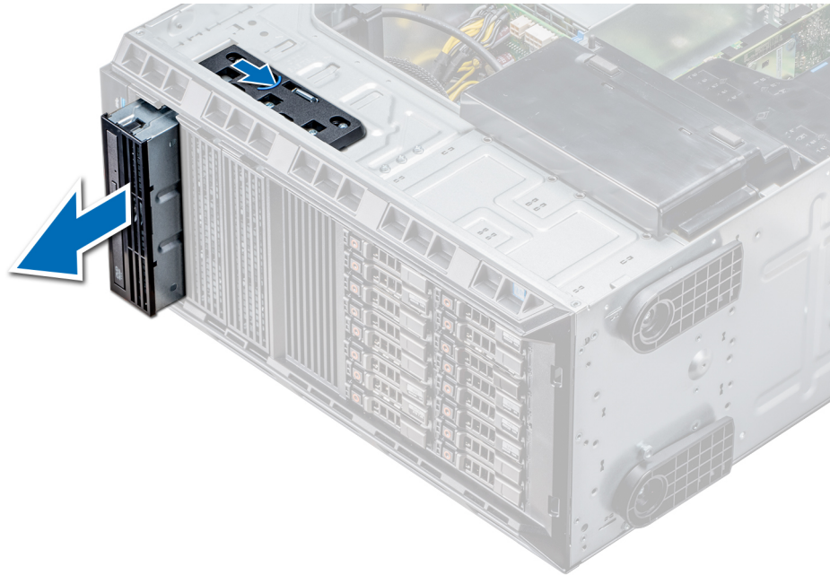
Ilustración 39. Extracción de la caja de la unidad óptica o la unidad de cinta
