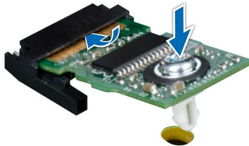
Figure 95. Installation du module TPM
