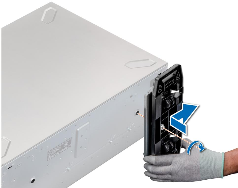
Figure 22. Installation des roulettes
