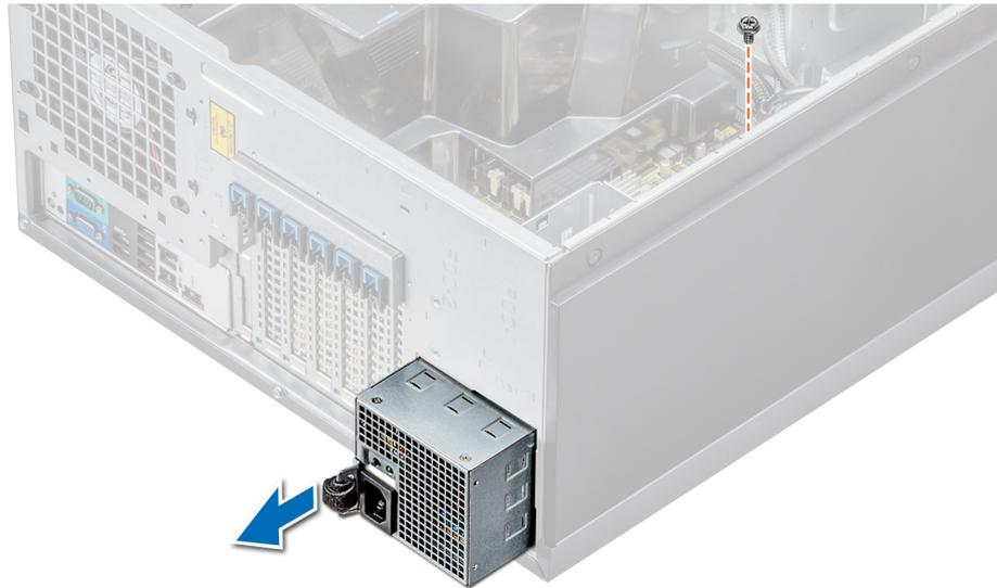
**Figure 83. Retrait d'un bloc d'alimentation câblé**
