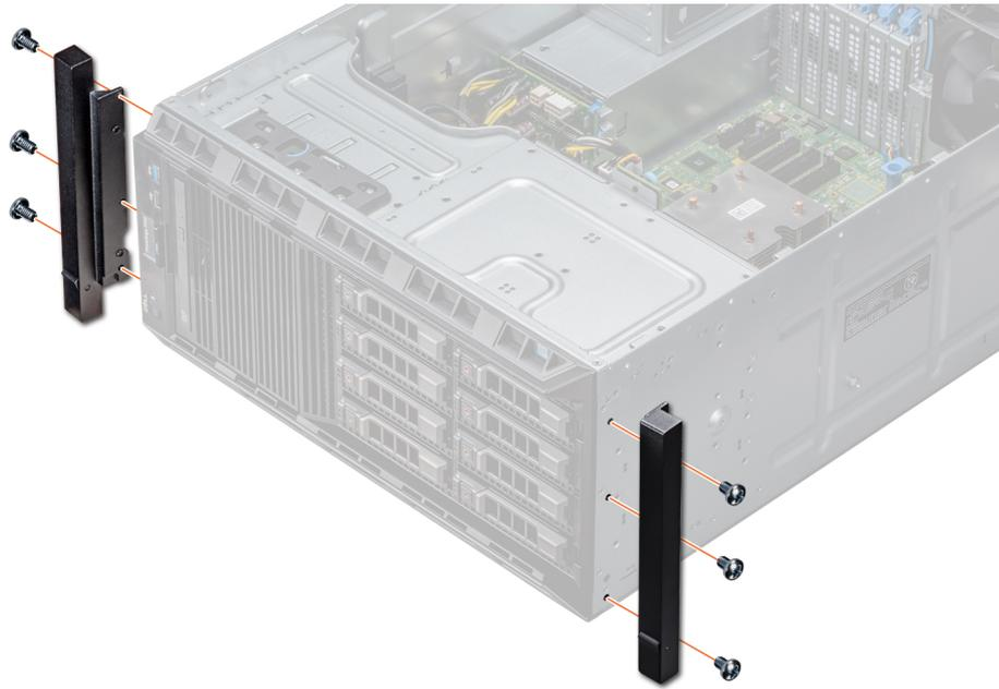
Figure 96. Installation des équerres sur le système
