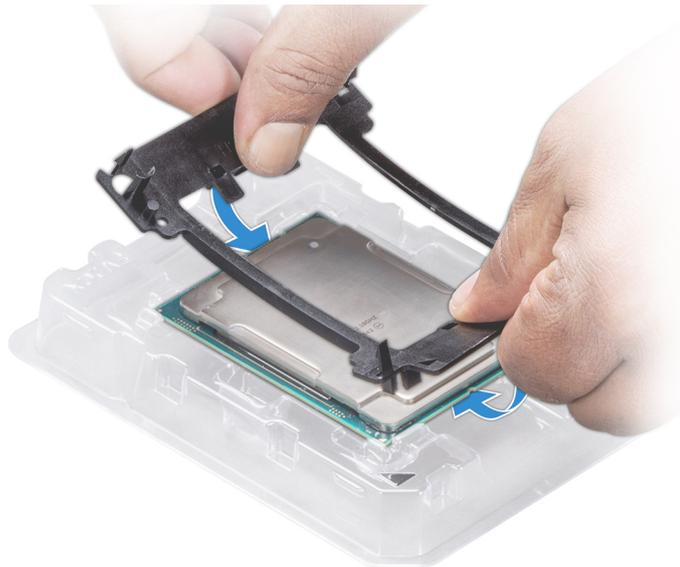
**Figure 75. Installation du support de processeur**
