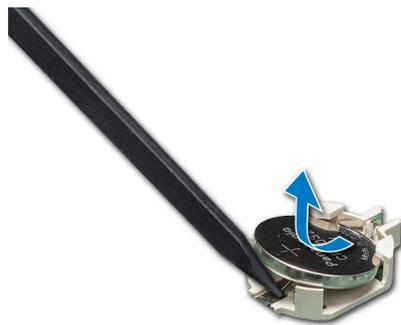
Figure 87. Retrait de la pile du système
