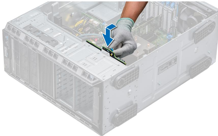
**Abbildung 52. Installieren der Festplattenrückwandplatine**
