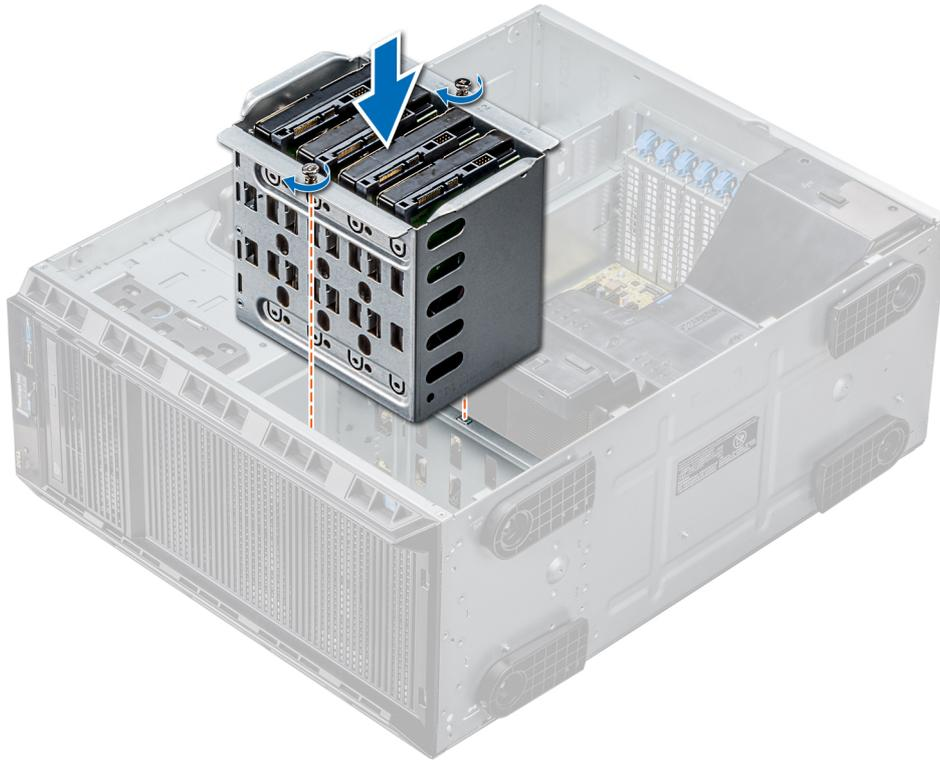
**Abbildung 42. Installieren eines internen Laufwerkschachts**
