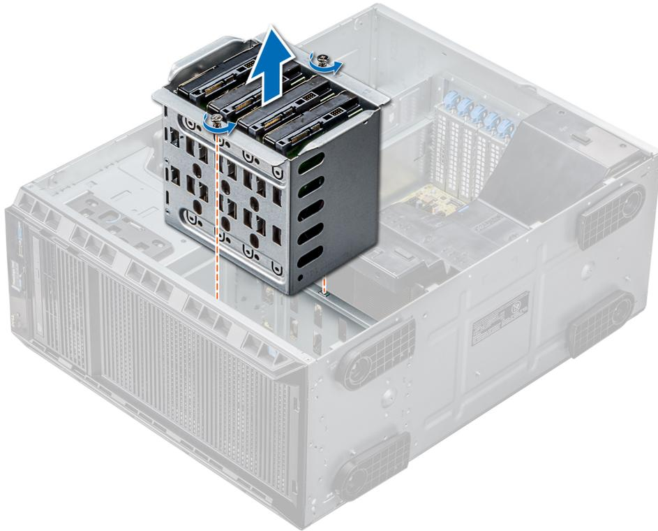
**Abbildung 41. Ausbauen eines internen Laufwerkschachts**
