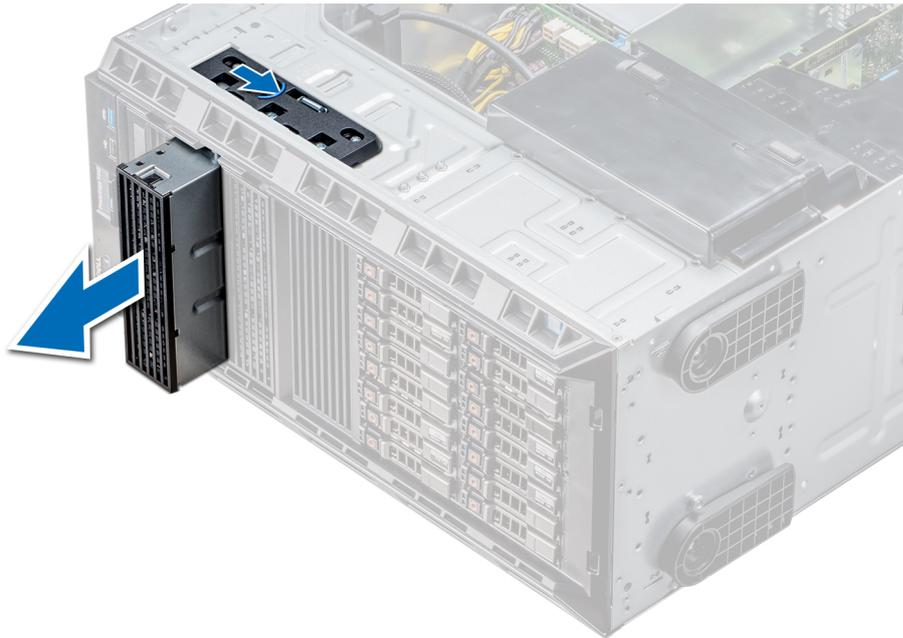
Abbildung 37. Entfernen des Platzhalters des optischen Laufwerks oder des Bandlaufwerks
