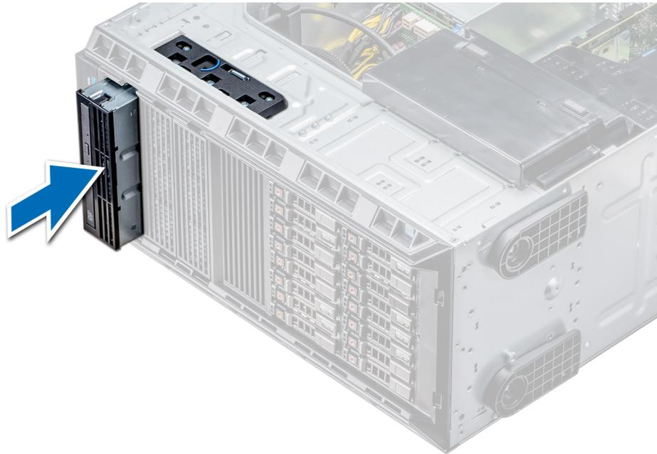
**Abbildung 40. Installieren des optischen Laufwerkgehäuses oder Bandlaufwerks**
