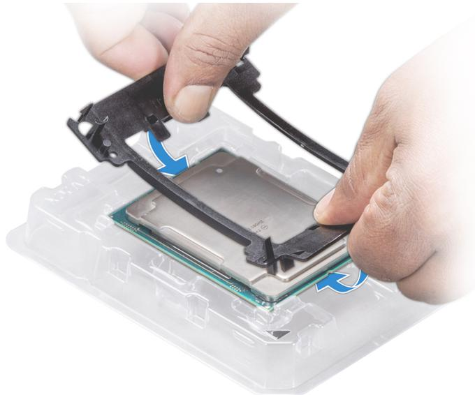
**Abbildung 75. Installieren der Prozessor-Halterung**
