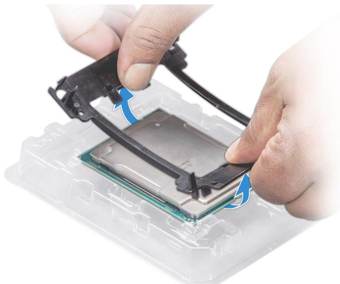
**Abbildung 74. Entfernen der Prozessorhalterung**
