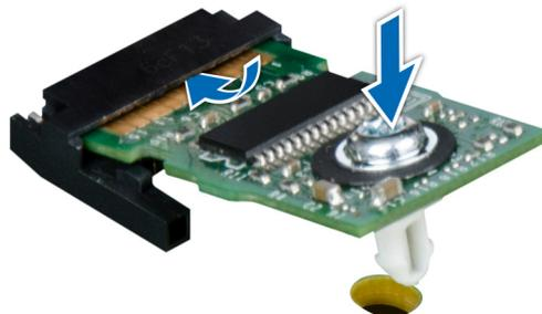
Abbildung 95. Installieren des TPM-Moduls
