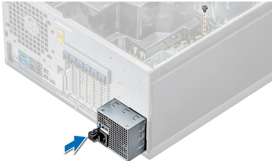
Abbildung 84. Installieren eines verkabelten Netzteils
