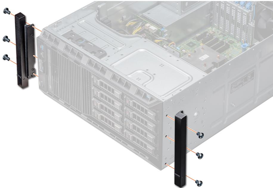
Abbildung 96. Installieren der Systemwinkel
