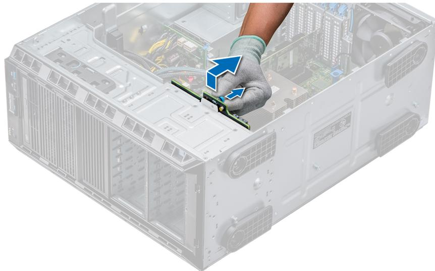
**Abbildung 51. Entfernen einer Rückwandplatine**
