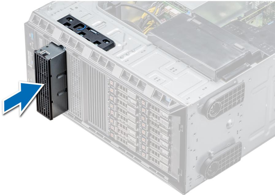
**Abbildung 38. Einsetzen des Platzhalters des optischen Laufwerks oder des Bandlaufwerks**
