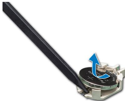
Figure 98. Retrait de la pile du système
