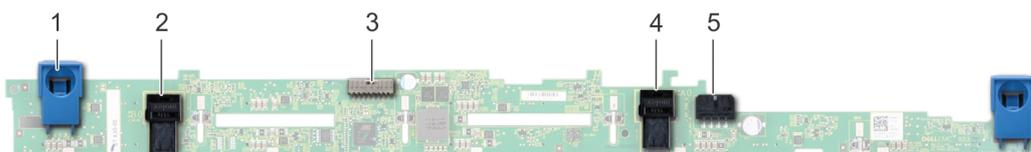
**Figure 81. Fond de panier à 8 disques de 2,5 pouces**
