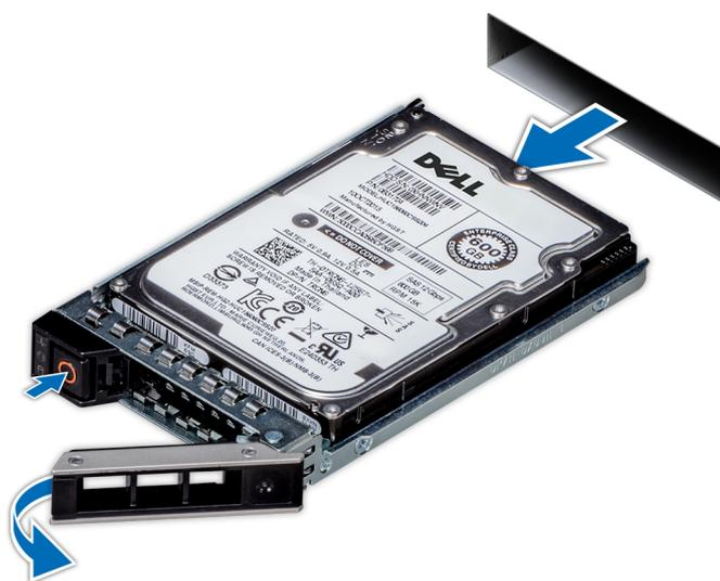
Figure 26. Retrait d'un support de disque
