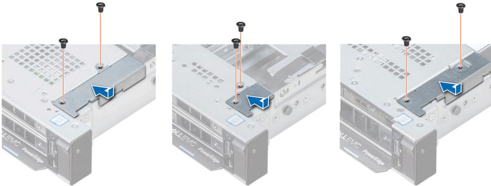
**Figure 120. Installation du cache-câbles**
