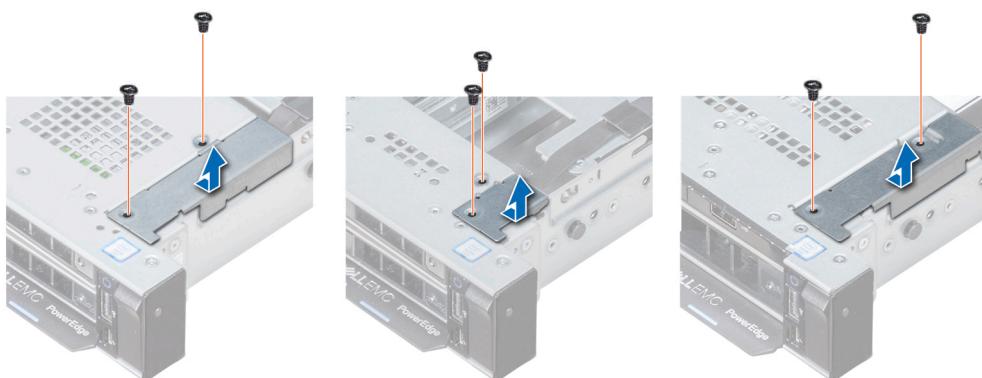
Ilustración 117. Extracción de la cubierta de cables
