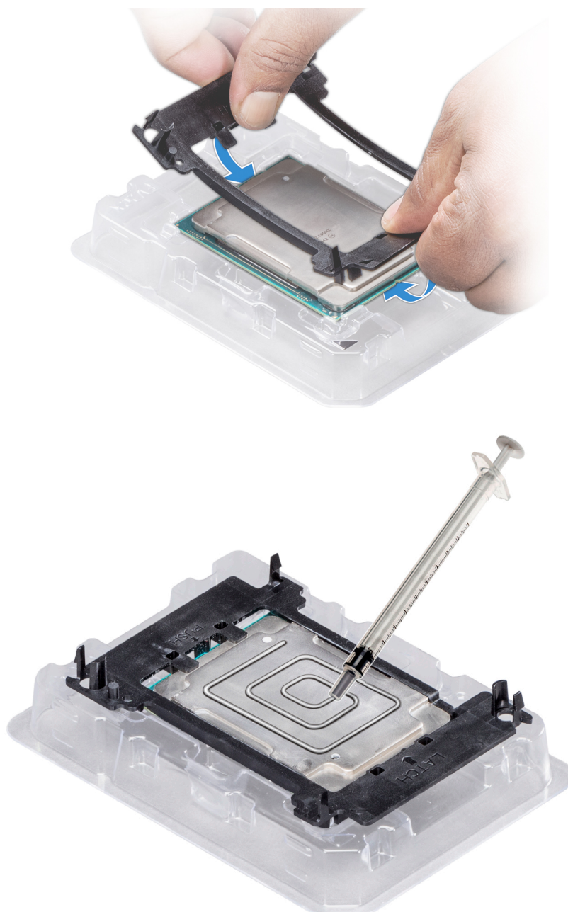
Ilustración 48. Aplicación de la pasta térmica en la parte superior del procesador
