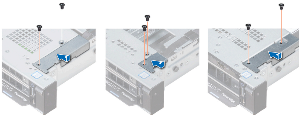
Ilustración 120. Instalación de la cubierta de cables
