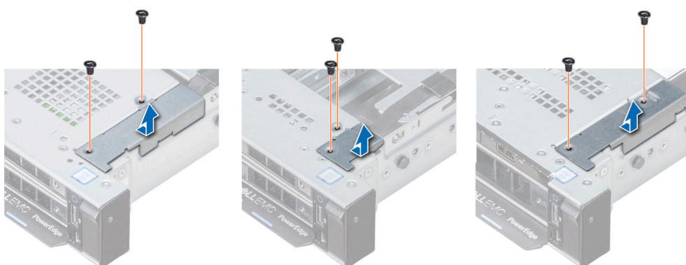
Abbildung 117. Entfernen der Kabelabdeckung
