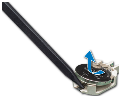
Abbildung 98. Entfernen der Systembatterie
