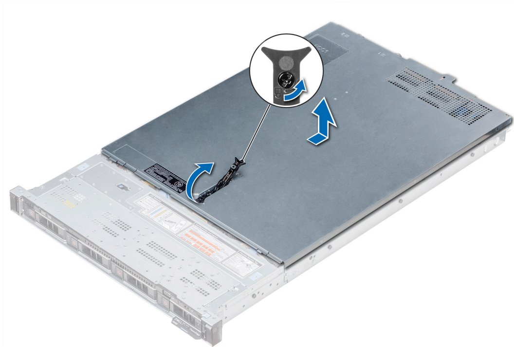
Abbildung 22. Entfernen der Systemabdeckung
