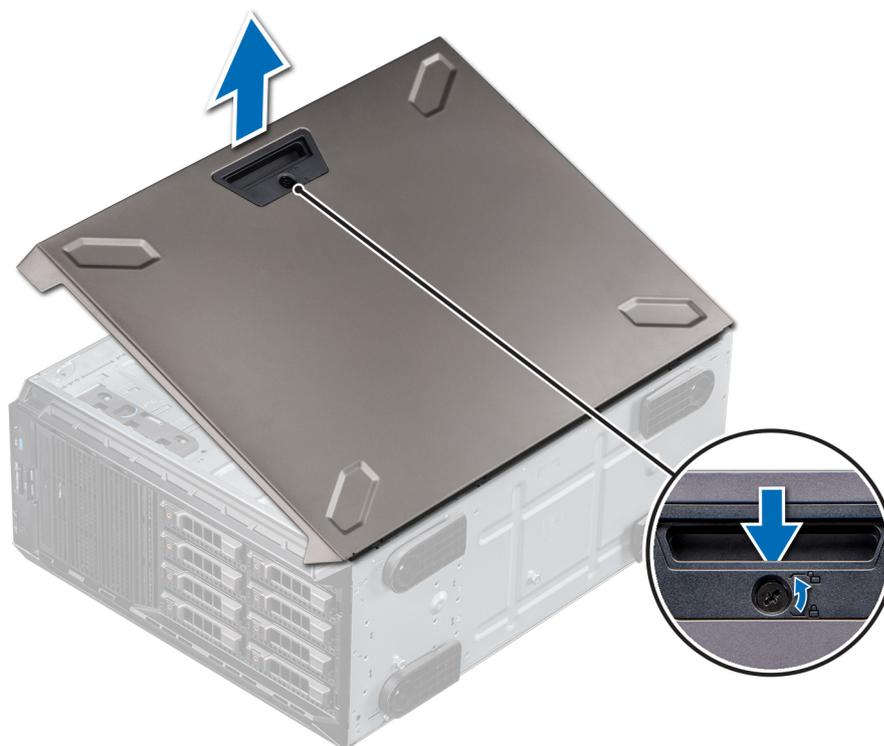
**Ilustración 22. Extracción de la cubierta del sistema**
