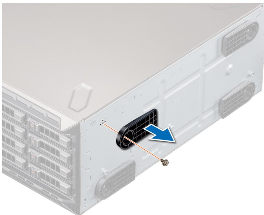
**Ilustración 19. Extracción de los pies del sistema**
