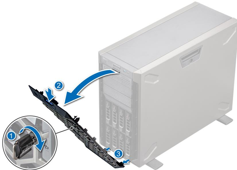
Abbildung 17. Entfernen der Frontverkleidung
