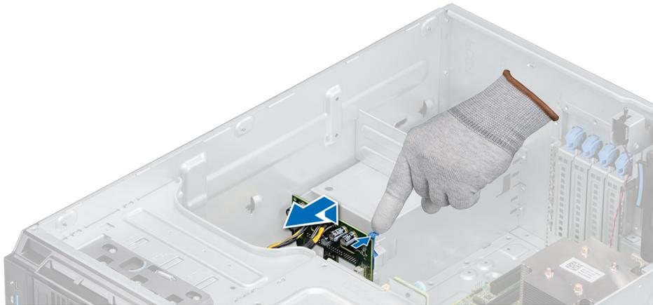
Abbildung 76. Entfernen der Stromzwischenplatte
