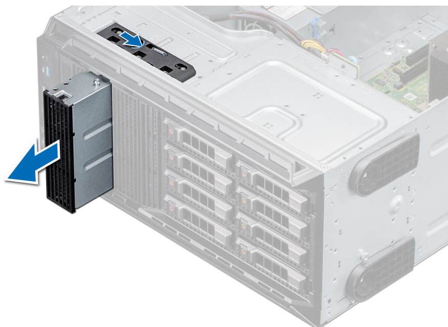
Figure 38. Retrait du cache de lecteur optique ou de bande
