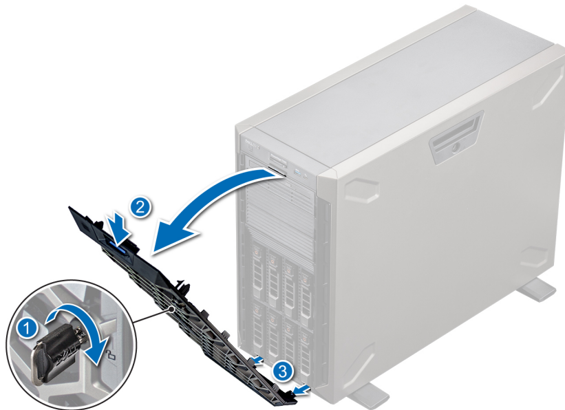
Figure 17. Retrait du cadre avant
