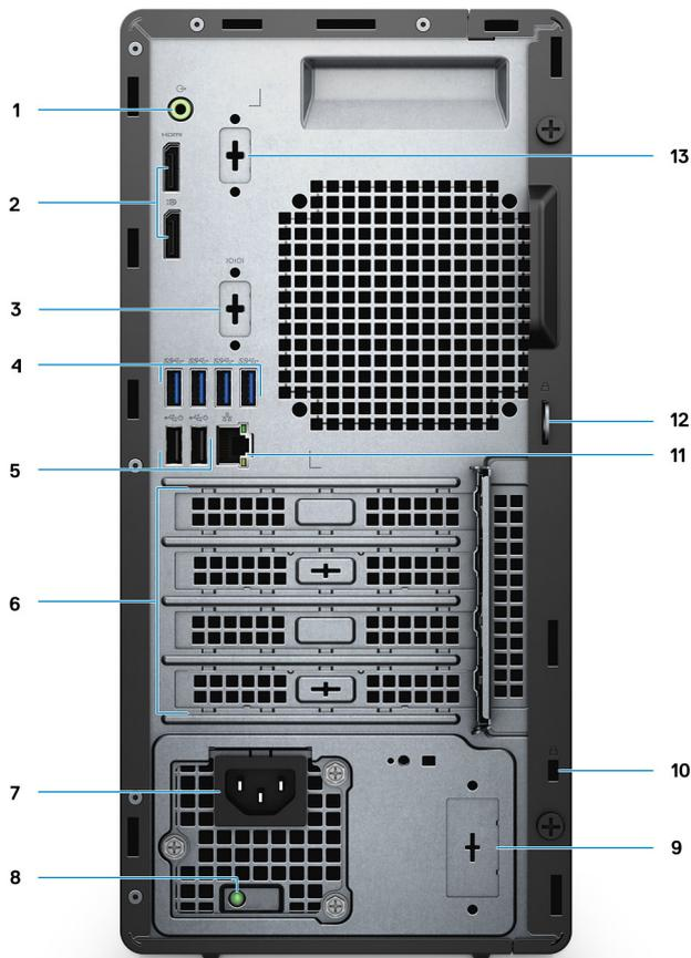
1. Umfunktionierbarer Audioanschluss (Line-out/Line-in)
