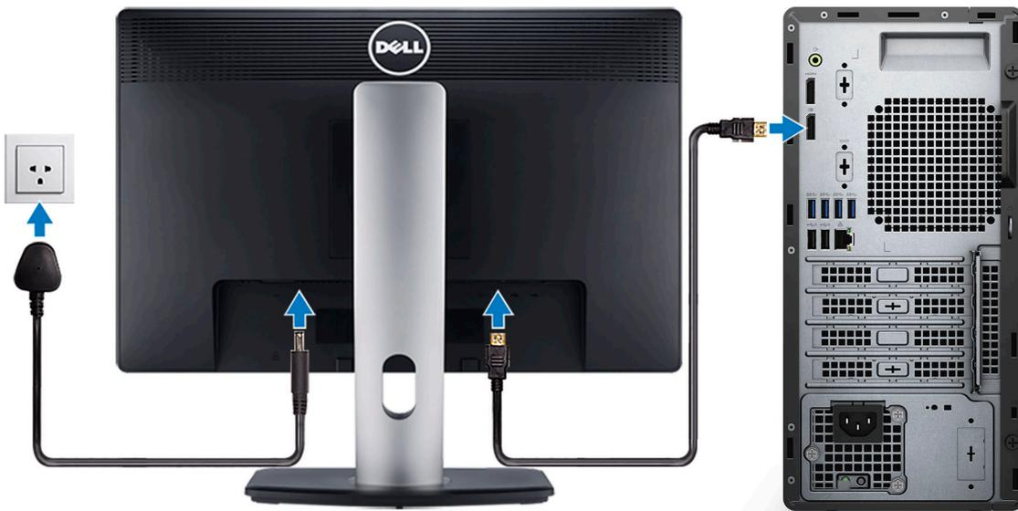
4. Schließen Sie das Stromkabel an.
