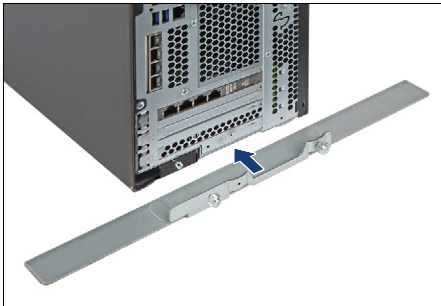
Immagine 16: Installazione della protezione antiribaltamento (A)
