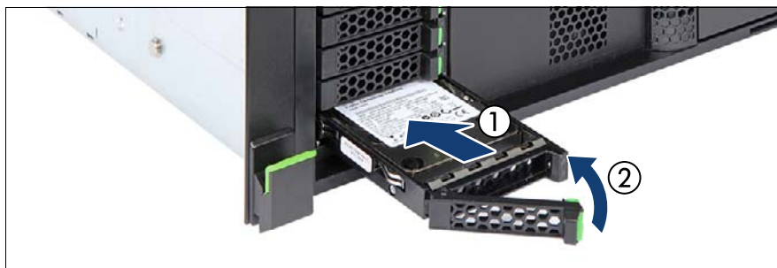
Immagine 26: Installazione del modulo HDD/SSD da 2,5 pollici
