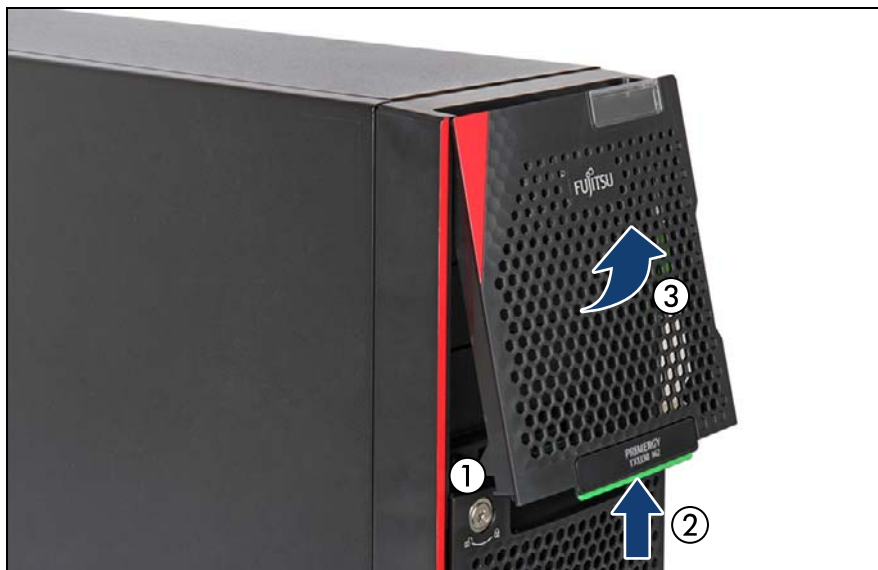
Immagine 21: Rimozione del pannello di copertura dello slot accessibile
