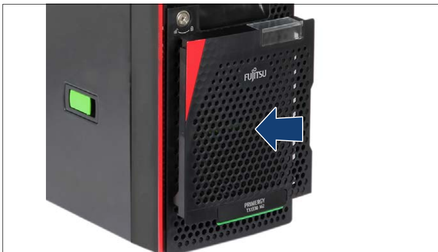
Immagine 22: Applicazione del pannello di copertura dello slot accessibile
