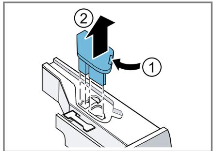
5. Den Deckel der Waschmittelschublade entrasten und entfernen.
