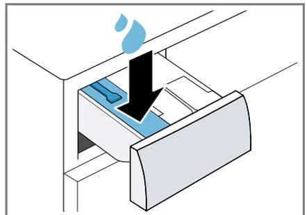
6. Das Pulvervollwaschmittel in die Kammer für manuelle Dosierung einfüllen.
