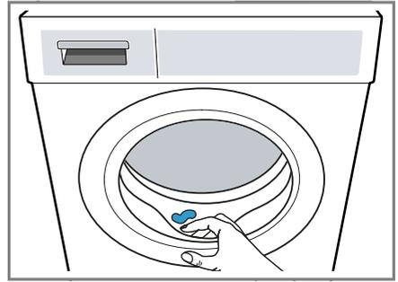
2. Die Tür und die Waschmittelschublade offen lassen, damit Restwasser abtrocknen kann.
