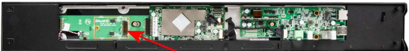
Das geöffnete D230 (Draufsicht): Position des M.2-Steckplatzes für das optionale LTE-Modul
