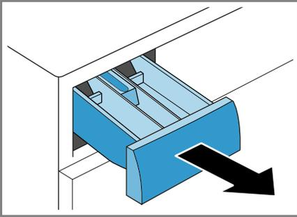
2. Den Einsatz runterdrücken und die Waschmittelschublade entnehmen.
