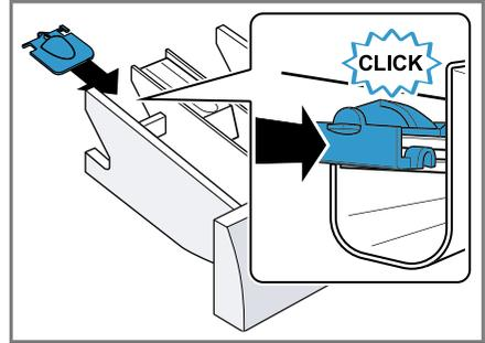
4. Die Waschmittelschublade einsetzen.
