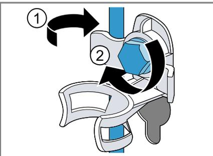
5. Den Schlauch in die Halterung einsetzen.
