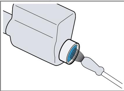
3. Den Wasserzulaufschlauch anschließen und auf Dichtheit prüfen.
