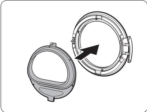
5. Setzen Sie die Glashalterung in die neu ausgerichtete Türabdeckung ein. Achten Sie darauf, dass sich das Türscharnier in der gleichen Position befindet wie in der Abbildung.
