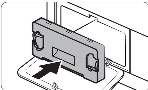
5. Setzen Sie die innere Abdeckung wieder in ihre ursprüngliche Position ein und fixieren Sie dann die Befestigungshebel.
