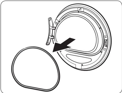
2. Verwenden Sie einen dünnen Gegenstand, um die Türdichtung zu entfernen.
