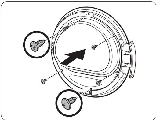
6. Ziehen Sie die oberen drei Schrauben an der Innenseite der Tür und die unteren drei Schrauben an der Glashalterung fest.
