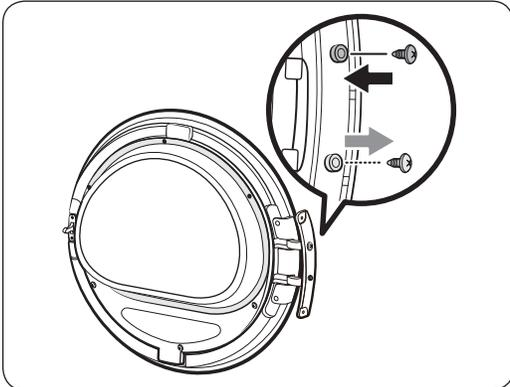
11. Entfernen Sie die Schraube unten am Scharnier und befestigen Sie sie an der Oberseite des Scharniers.
