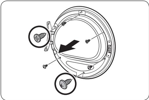
3. Entfernen Sie die oberen drei Schrauben an der Innenseite der Tür und die unteren drei Schrauben an der Glashalterung.
