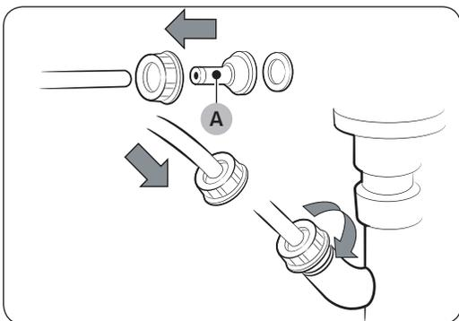
1. Montieren Sie den **Schlauchanschluss (A)** und befestigen Sie ihn am Ende des Zubehörschlauchs (siehe Abbildung).
