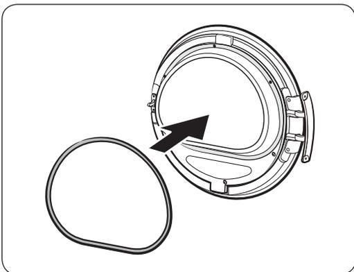
7. Setzen Sie die Türdichtung in der richtigen Orientierung ein.
