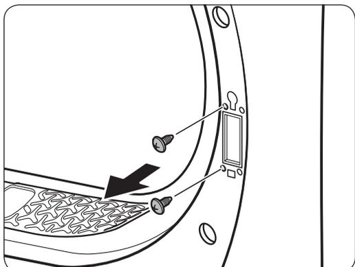
8. Entfernen Sie die 2 Schrauben, die nach dem Abnehmen des Türscharniers verblieben sind.
