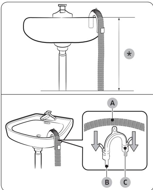
1. Stellen Sie sicher, dass der Auslass des Zubehörschlauchs sich in weniger als **90 cm (\*)** über dem Boden des Wäschetrockners befindet.
