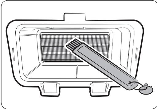
3. Entfernen Sie mit der mitgelieferten Bürste den Staub auf dem Wärmetauscher.
