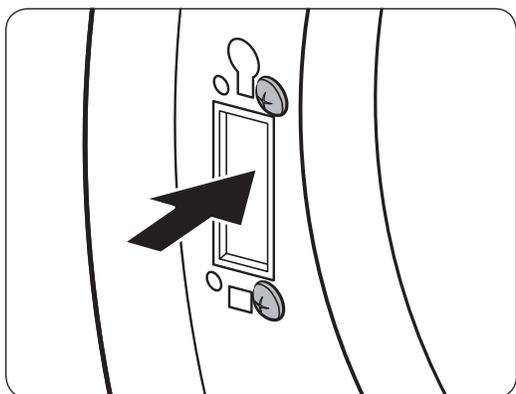
10. Ziehen Sie die 2 Schrauben, die in Schritt 8 entfernt wurden, auf der gegenüberliegenden Seite am Scharnierrahmen fest. Beachten Sie, dass Sie sie an der rechten Seite des Scharnierbands (oben rechts und unten rechts) festziehen müssen.
