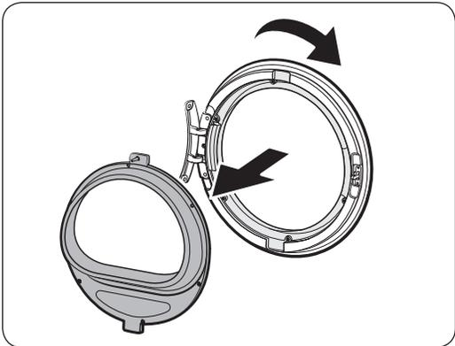
4. Entfernen Sie die Glashalterung und drehen Sie dann die Türabdeckung um 180 Grad.
