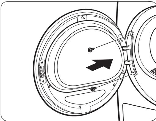
12. Setzen Sie das Türscharnier auf der gegenüberliegenden Seite ein und ziehen Sie die 2 Schrauben fest, um die Tür am Wäschetrockner zu befestigen.
