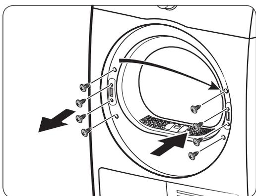
9. Entfernen Sie die 4 Schrauben am Türriegel. Entfernen Sie den Türriegel und setzen Sie ihn auf der gegenüberliegenden Seite wieder ein.
