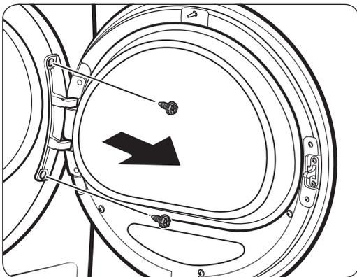
1. Öffnen Sie die Tür und entfernen Sie anschließend die beiden Schrauben am Türscharnier. Fassen Sie die Tür mit beiden Händen und heben Sie sie leicht an, um sie abzunehmen.
