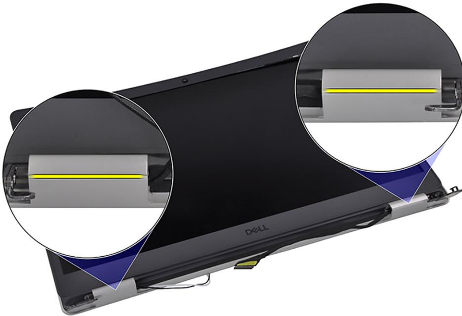
4. Haga palanca para abrir el bisel de la pantalla desde el borde interno en la parte inferior del ensamblaje de la pantalla.
