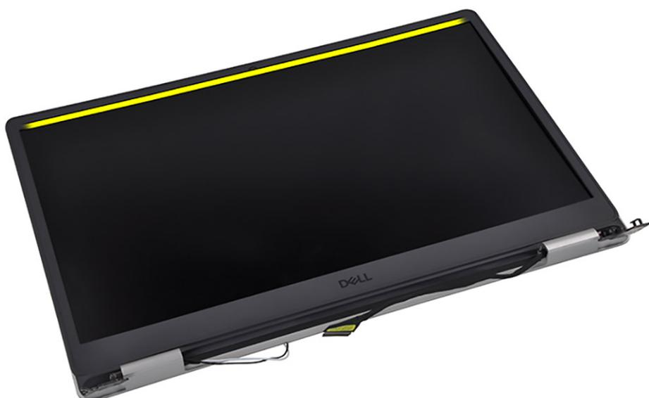
3. Haga palanca para abrir las tapas de las bisagras en la parte inferior del ensamblaje de la pantalla.
