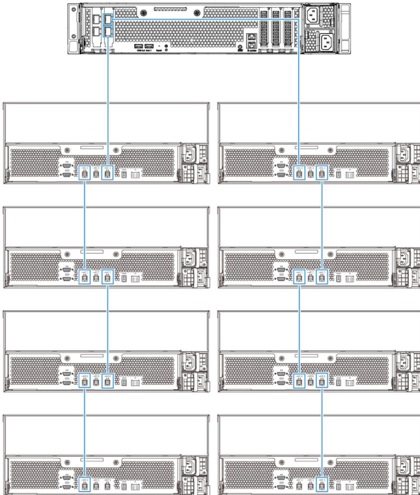
QNAP consiglia di usare sempre una configurazione a due percorsi per evitare l'inattività dell'archiviazione dovuta a malfunzionamenti dell'unità di espansione o lo scollegamento del cavo. La configurazione a singolo percorso deve essere usata solo in casi in cui non è possibile usare la configurazione a due percorsi.
