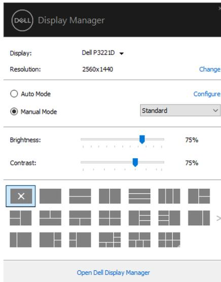
El cuadro de diálogo **Configuración rápida** también proporciona acceso a la interfaz de usuario avanzada de Dell Display Manager, que se utiliza para ajustar funciones básicas, configurar el modo automático y acceder a otras funciones.
