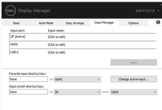
Puede utilizar la lista desplegable para cambiar a cualquier fuente de entrada.
