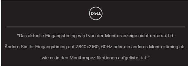
Das bedeutet, dass sich der Monitor mit dem vom Computer empfangenen Signal nicht synchronisieren kann. Den durch diesen Monitor adressierbaren horizontalen und vertikalen Frequenzbereich finden Sie unter [Technische Daten des Monitors](#). Empfohlener Modus ist 3840 x 2160.
