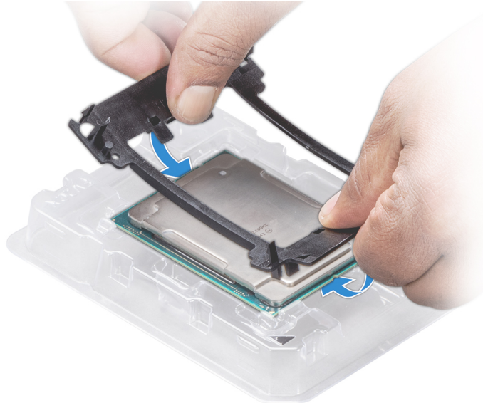
Ilustración 60. Instalación del soporte del procesador
