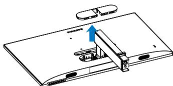
4. Šroubovákem odmontujte šrouby na rameni a potom oddělte rameno/stojan od monitoru.
