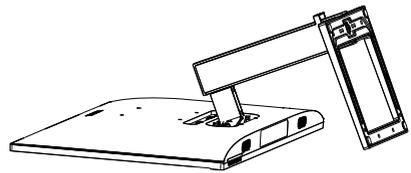
2. Lösen Sie die Schraube an der Unterseite der Basis mit einem Schraubendreher fest; entfernen sie die Basis vom Ständer.
