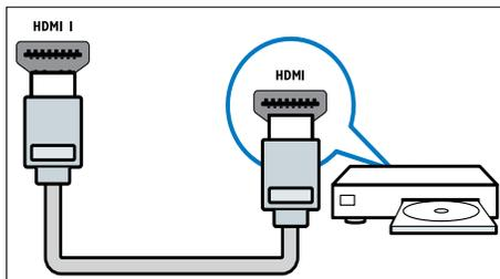
Les raccordements via le connecteur DVI ou VGA requièrent un câble audio supplémentaire (voir 'Connexion d'un ordinateur' à la page 39).
