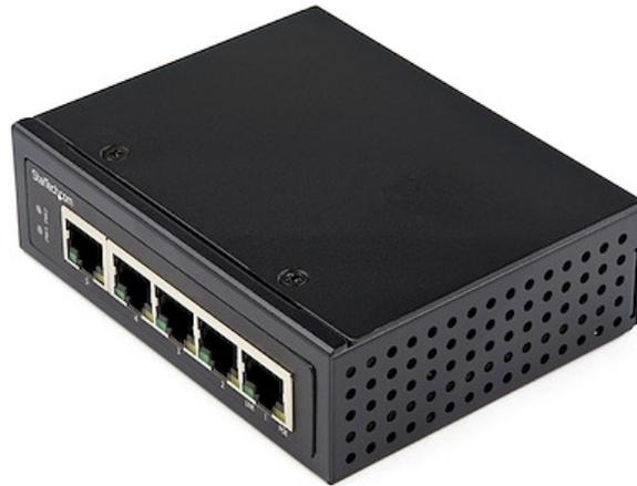
Este conmutador industrial Gigabit PoE de 5 puertos (4 puertos PoE) incluye 30W de alimentación y está diseñado para su instalación en entornos de condiciones extremas, además de ser compatible con un total de 120W de alimentación nominal (salidas).
