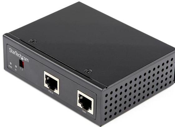
Multiplica una conexión PoE (90W máximo) en datos separados (RJ45) y alimentación CC (bloque de terminales), lo cual permite la alimentación de cualquier dispositivo que utilice alimentación CC entre 12V a 48V CC (1,5A). Alimiente dispositivos que no utilizan alimentación PoE mediante la infraestructura de red, cuando no hay alimentación disponible.
