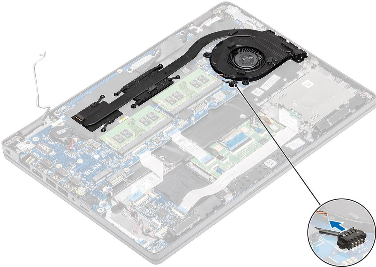
2. Retirez les six vis (M2x3) qui fixent l'assemblage du dissipateur de chaleur à la carte système [1].
