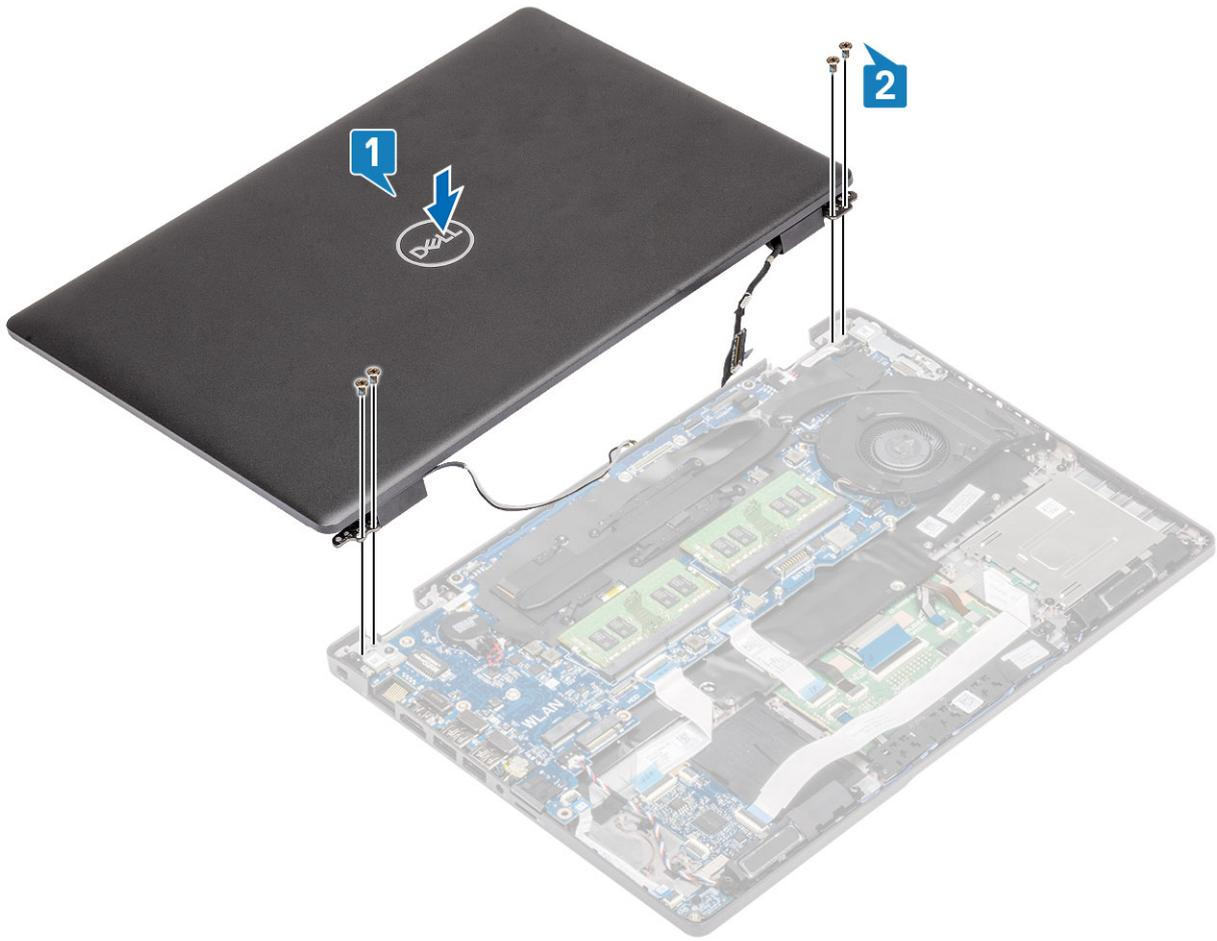
3. Mettez en place le châssis du système sur l'assemblage d'écran.
