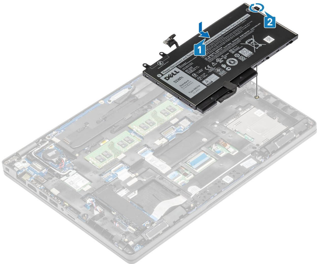
3. Branchez le câble de la batterie sur le connecteur situé sur la carte système.
