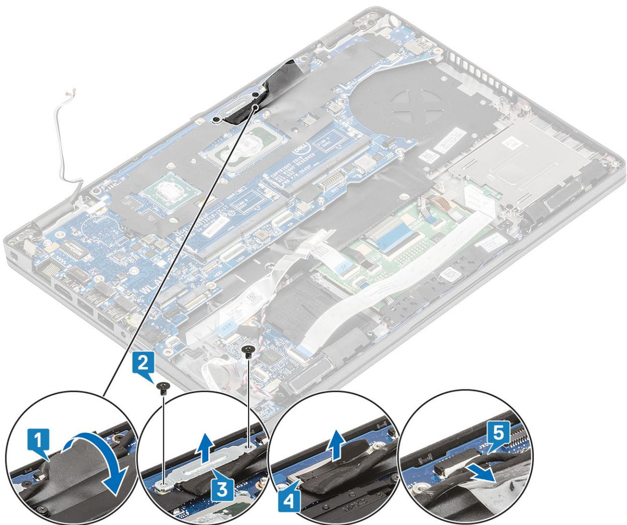
10. Retirez les deux vis (M2x3) qui fixent la carte système sur le repose-mains [1].
