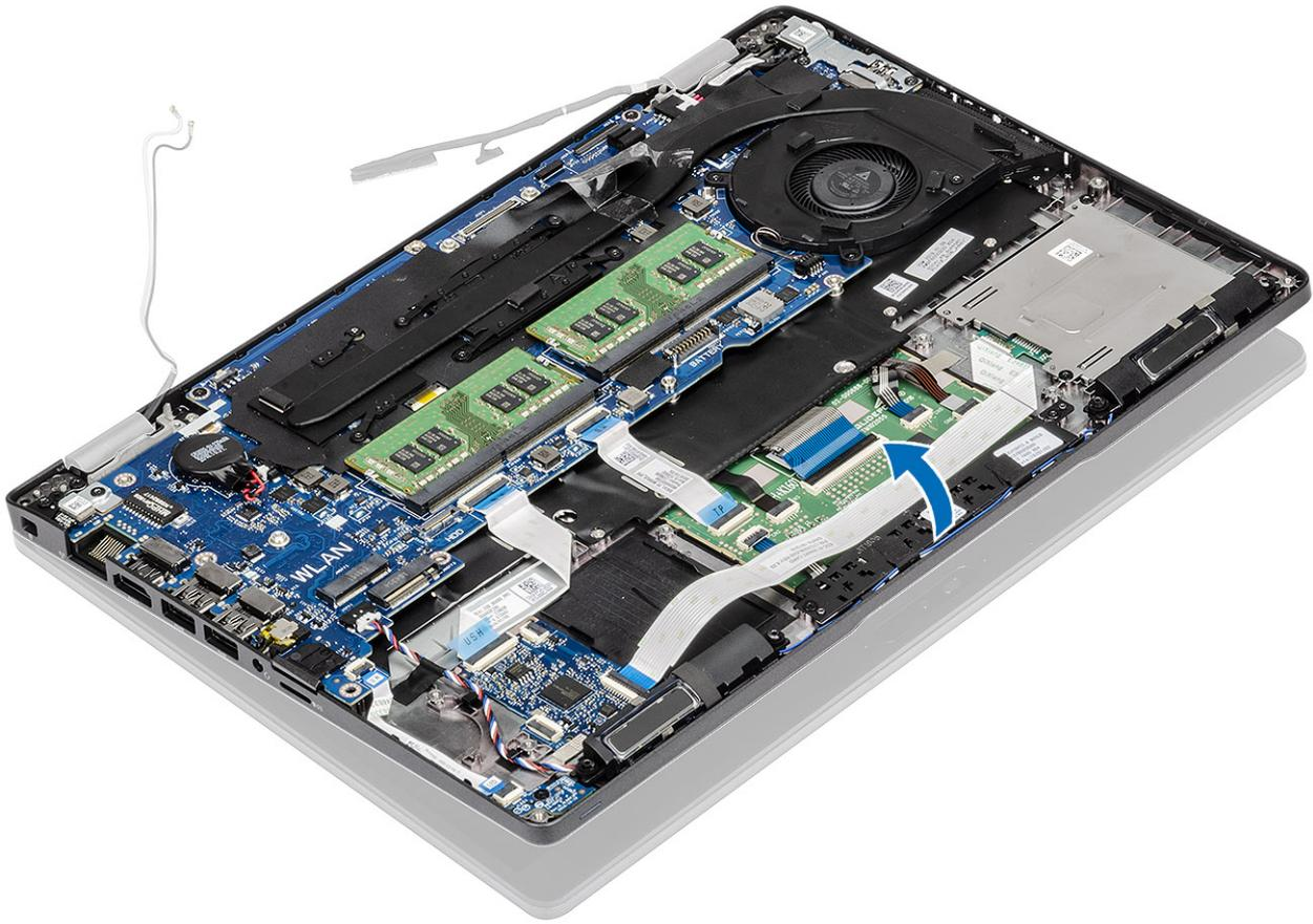
7. Retirez les quatre vis (M2,5x5) qui fixent l'assemblage d'écran au châssis du système [1].
