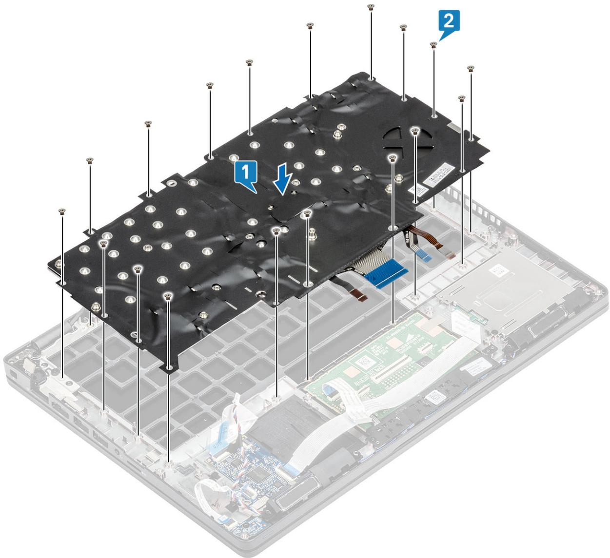
3. Branchez le câble de rétroéclairage et le câble du clavier sur les connecteurs situés sur le pavé tactile.
