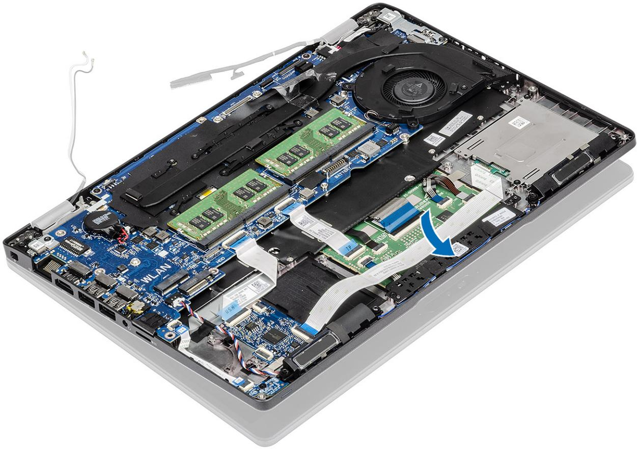
4. Repassez l'antenne sans fil dans les guides d'acheminement situés sur la carte système [1].
