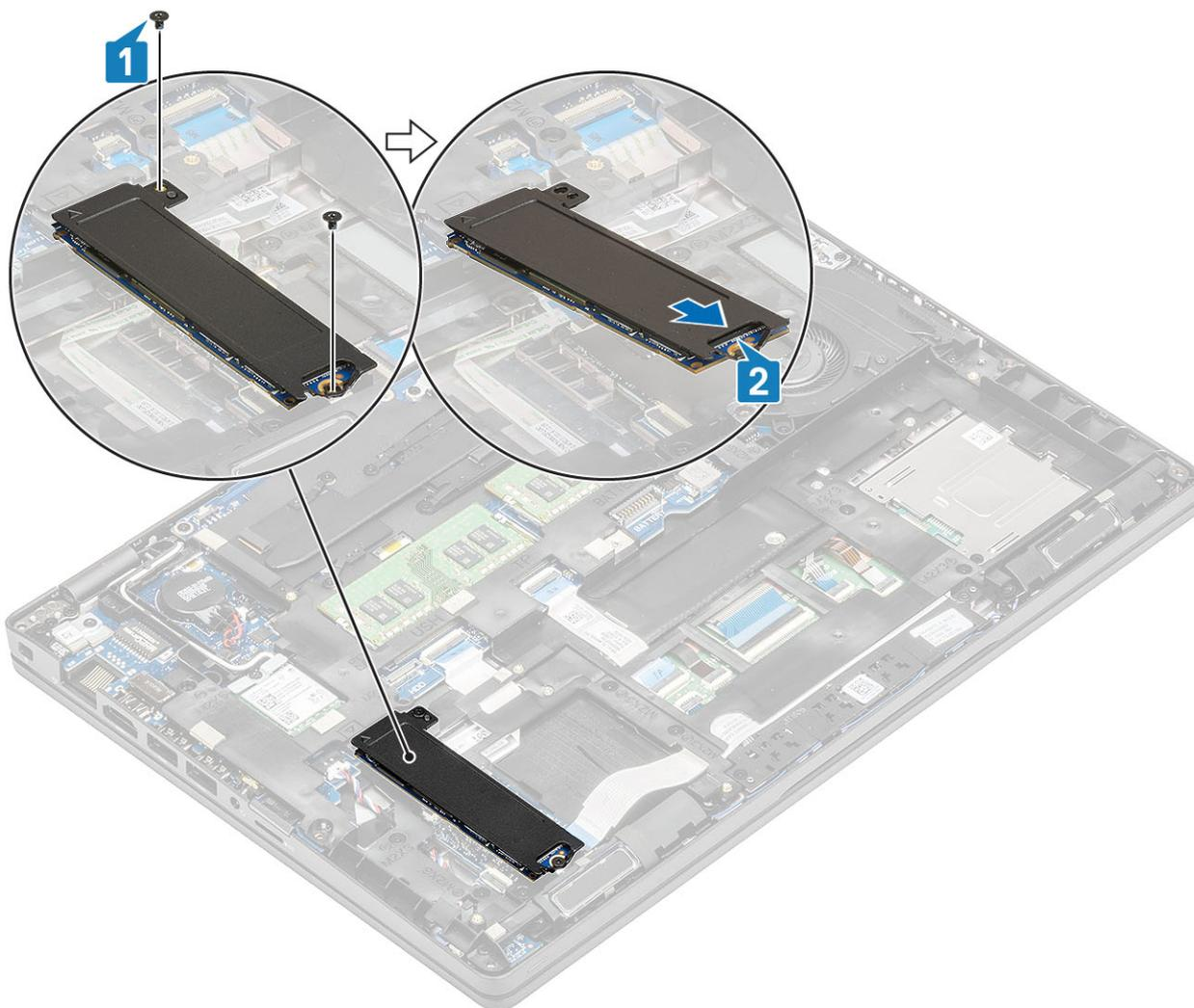
3. Retirez le disque SSD de la plaque thermique SSD.
