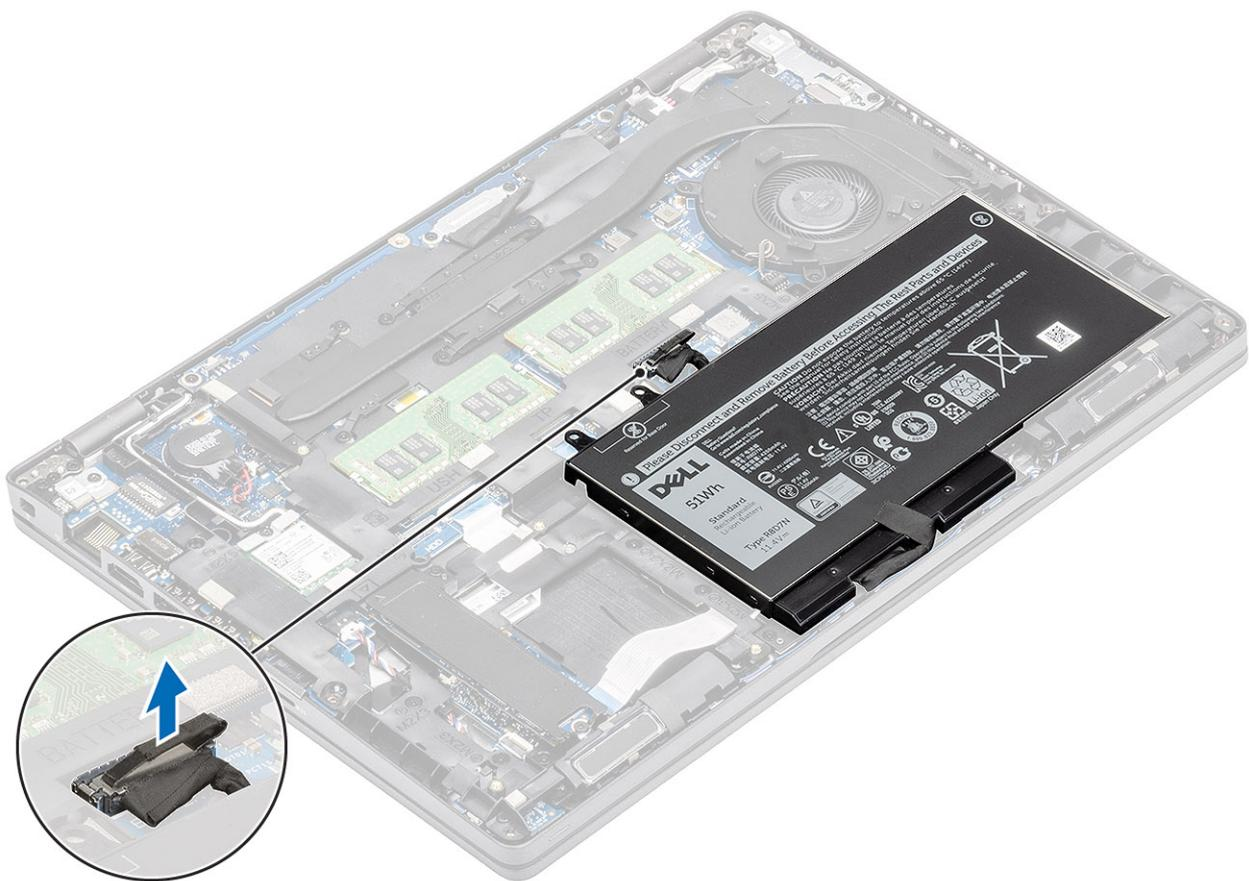
2. Desserrez la vis imperdable unique qui fixe la batterie sur le repose-mains [1].
