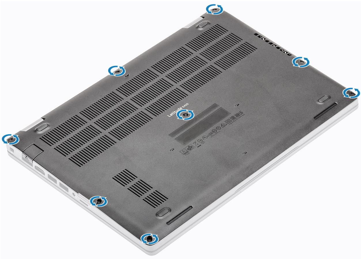
2. À l'aide d'une pointe en plastique [1], faites levier sur le cache de fond en commençant par le coin supérieur gauche, puis poursuivez sur les côtés pour l'ouvrir.
