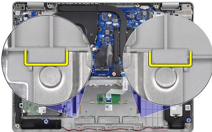
8. Alinee los orificios para tornillos del soporte del panel táctil con los orificios para tornillos del ensamblaje del teclado y el reposamanos.
