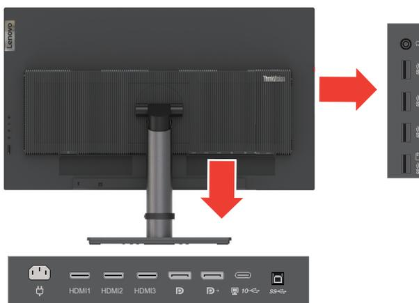
3. Connettere una estremità del cavo HDMI al connettore HDMI del monitor e l'altra estremità al computer.
