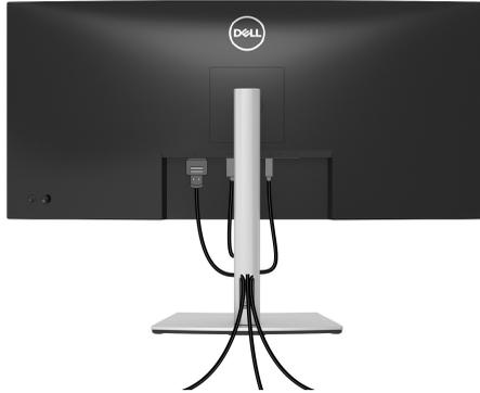
Después de conectar todos los cables necesarios al monitor y al PC, (consulte [Conexión de su monitor](#) para conectar los cables), utilice la ranura de sujeción de cables para organizarlos correctamente tal y como se muestra arriba.
