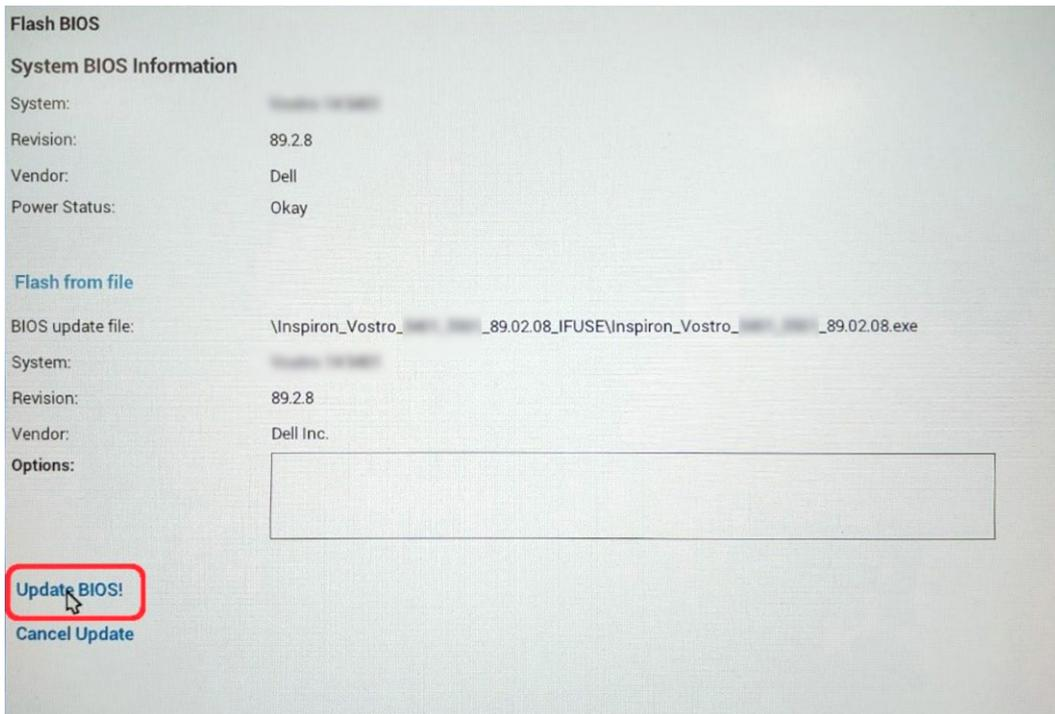
7. Sobald der Vorgang abgeschlossen ist, wird das System neu gestartet, und die BIOS-Aktualisierung ist abgeschlossen.
