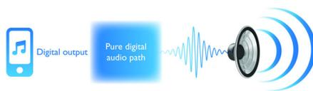
La mayoría de altavoces base utilizan la salida analógica del iPod, iPhone o iPad, y la convierten en digital, lo que produce algo de ruido adicional y pérdida de detalles. Mediante el uso de la salida digital del reproductor, el altavoz mantiene la integridad de la señal musical, lo que produce una mayor relación señal-ruido y una mejor resolución.
