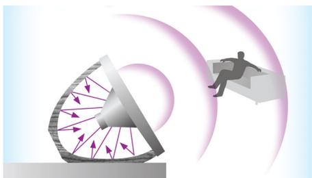
El diseño en curva especialmente cuidado de la cubierta posterior de este altavoz base de Philips crea una estructura acústica de gran efectividad para la reproducción del sonido. Su curvatura perfectamente definida refuerza la rigidez de la carcasa del altavoz, lo que reduce de forma espectacular la resonancia interna y elimina la vibración y la distorsión del sonido. De esta forma, puedes disfrutar de un sonido increíblemente nítido en unos altavoces de diseño sorprendente.
