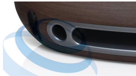
Il carico acustico bass-reflex utilizza un bass pipe sintonizzato sul volume acustico della cassa altoparlante per riprodurre bassi profondi da strutture compatte. Il bass-pipe appositamente progettato aiuta il flusso d'aria e genera bassi profondi e potenti, anche ad alto volume, e riduce al minimo la turbolenza dell'aria che potrebbe causare deformazione.
