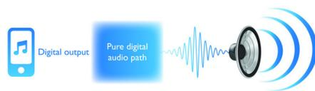
La maggior parte degli altoparlanti docking utilizza l'uscita analogica del tuo iPod, iPhone o iPad e la riconverte in digitale, causando rumore e perdita dei dettagli. Utilizzando l'uscita digitale del tuo lettore, l'altoparlante mantiene l'integrità del segnale audio, per un rapporto segnale/rumore più alto e risoluzione ottimizzata.
